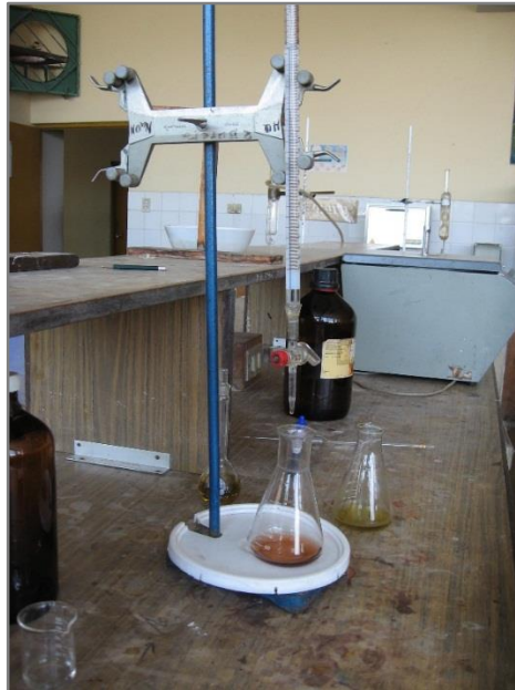
Figura 13. Titulación con la solución de Sulfato ferroso 0,1 N.
