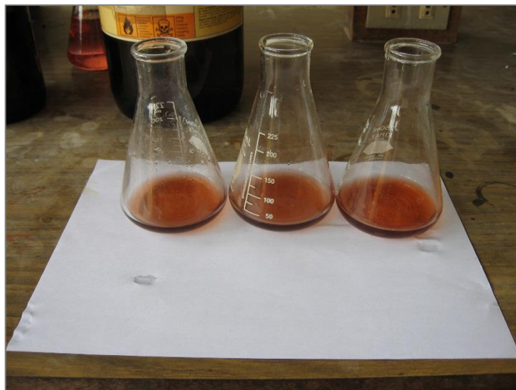
Figura 14. Cambio de color de verde brillante a rojo en la titulación con la solución de sulfato ferroso 0,1 N.
