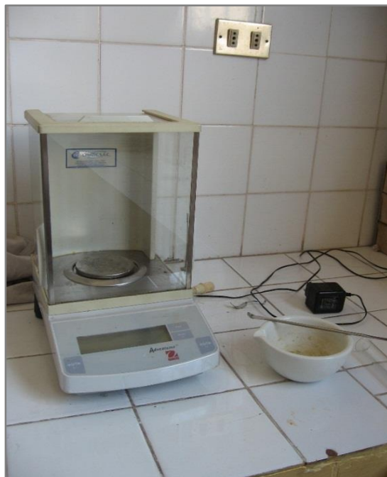
Figura 8. La pesada de la muestra finamente molida para el análisis de carbono
