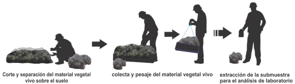
Figura 14. Pasos para la medición de materia viva sobre el suelo del tillandsial.
