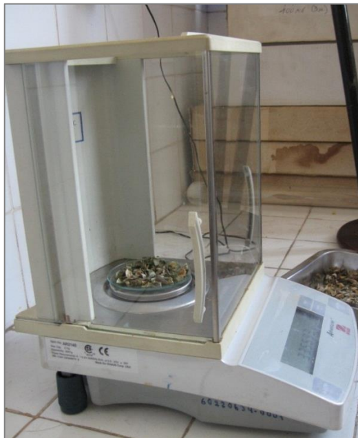
Figura 4. El pesaje de la muestra seca para la determinación de la humedad
