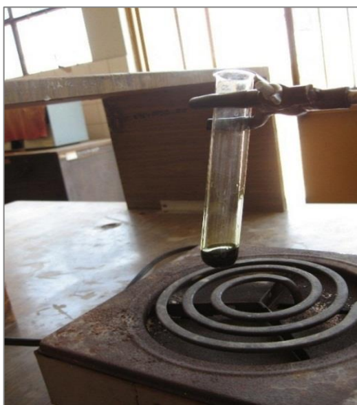
Figura 11. El calentamiento de la solución a una temperatura de 155^{\circ}\text{C} en una cocina eléctrica.
