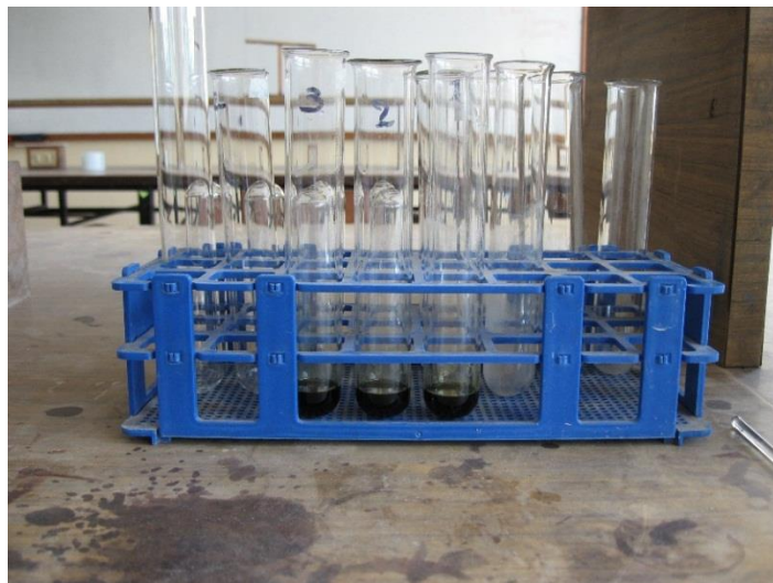
Figura 10. Los tubos de ensayo con la mezcla de la muestra con el ácido sulfúrico y el dicromato de potasio
