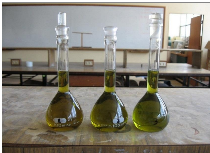
Figura 12. La transferencia de la solución a una fiola de 100 ml para la toma de una alícuota para la titulación con la solución ferrosa.
