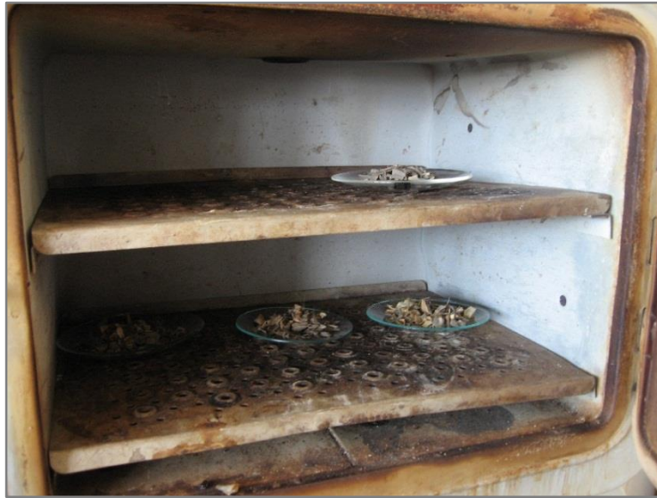
Figura 3. El secado de las muestras de tejido vegetal en estufa a 80 °C
