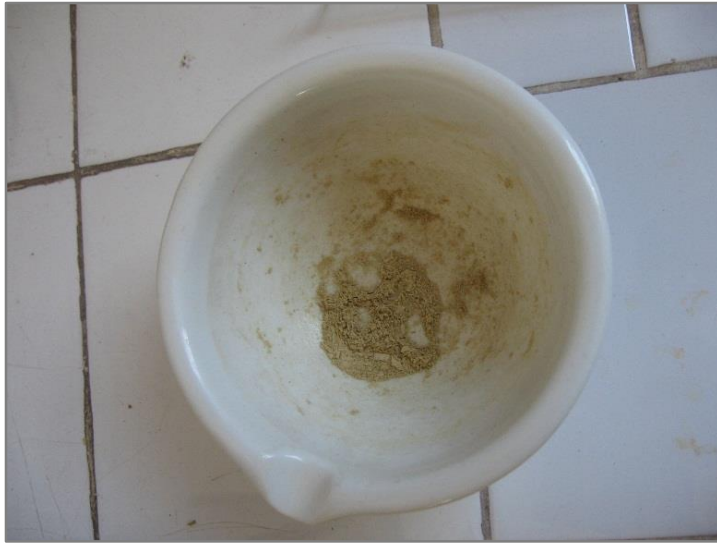
Figura 7. La molienda de la muestra seca en un mortero de porcelana
