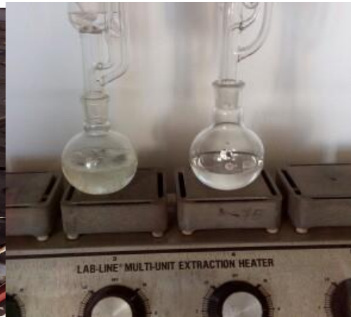
Determinación del contenido de grasa del bizcocho edulcorado con panela a través del método de Soxhlet.
