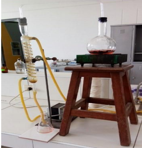
Determinación de proteínas por método de Kjeldahl, al bizcocho edulcorado con panela.
