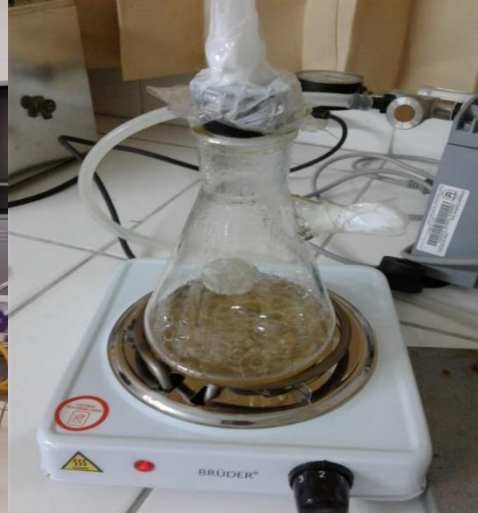
Determinación de fibra cruda por digestión ácido- alcalina, al bizcocho edulcorado con panela.
