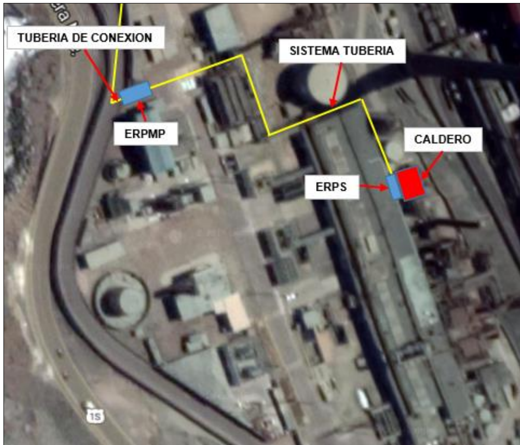
Figura 46. Vista de componentes del sistema suministro gas natural Fuente: Elaboración propia.
