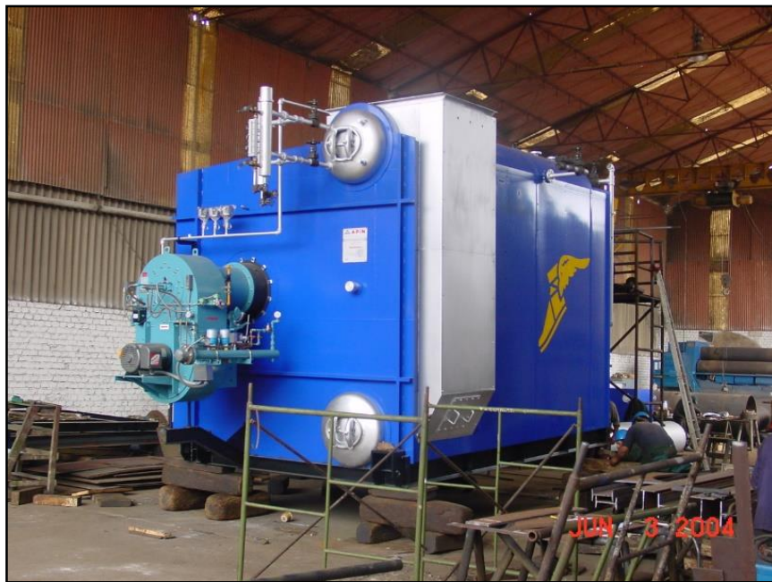
Figura 44. Caldera APIN de 700 HP
