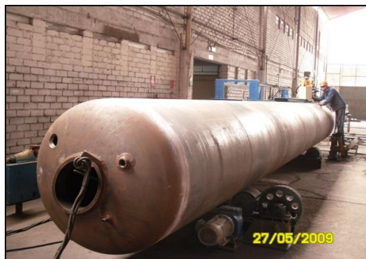
Figura 26. Domo de vapor Fuente: TEGNOLOG, 2014.
