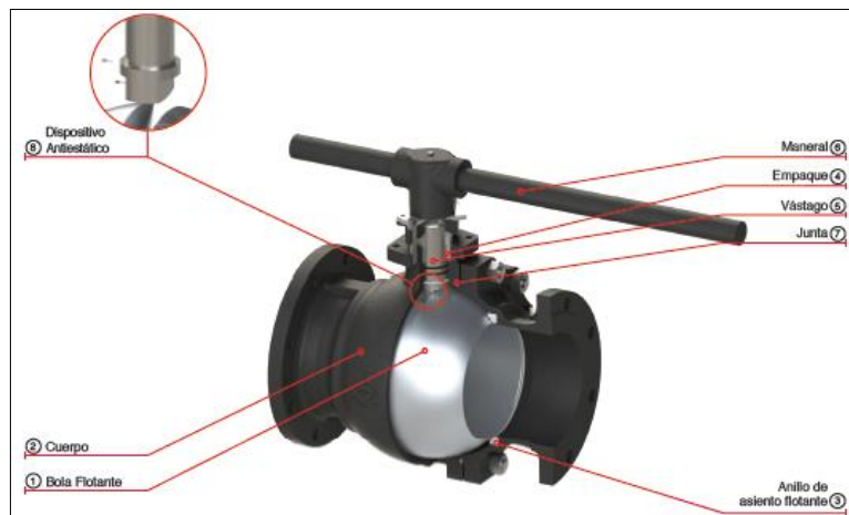
Figura 41. Esquema de válvula de bola flotante
