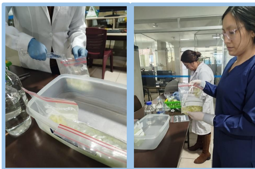
Fotografía 4. Proceso de lavado de muestras con agua destilada para sedimentación por 24 h.
