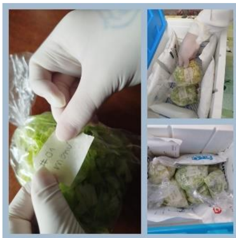
Fotografía 2. Rotulado e identificación por tipo de establecimiento y almacenamiento en cooler con acumuladores de frío.
