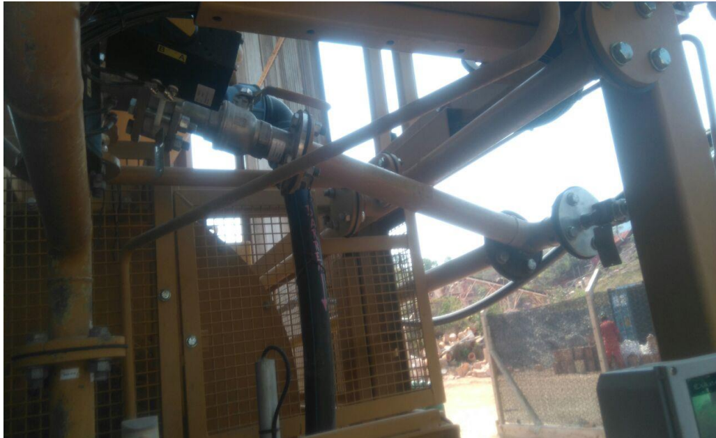
Figura 23. Entrada de oxígeno y pulpa al equipo Gekko ILR 150 proveniente de concentradores gravimétricos. Fuente: Elaboración propia.
