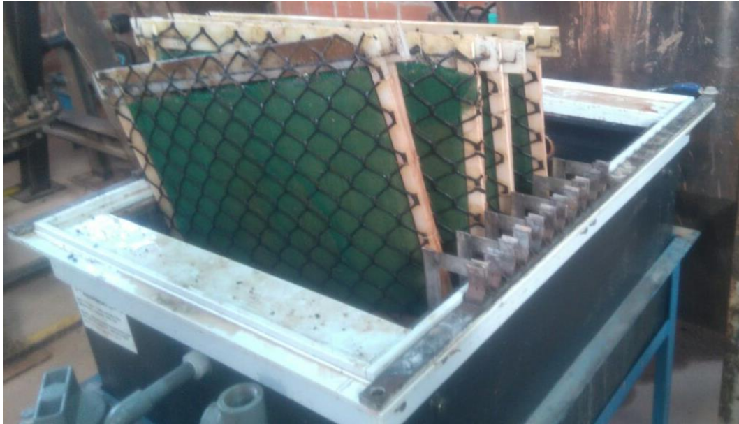
Figura 32. Disposición de cátodos y ánodos en celda de electrodeposición de oro. Fuente: Elaboración propia.
