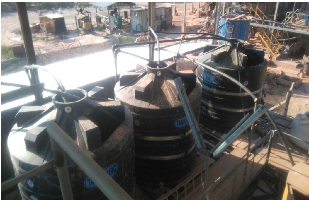
Figura 20. Disposición de tanques de agua y cianuro de sodio. Fuente: Elaboración propia.
