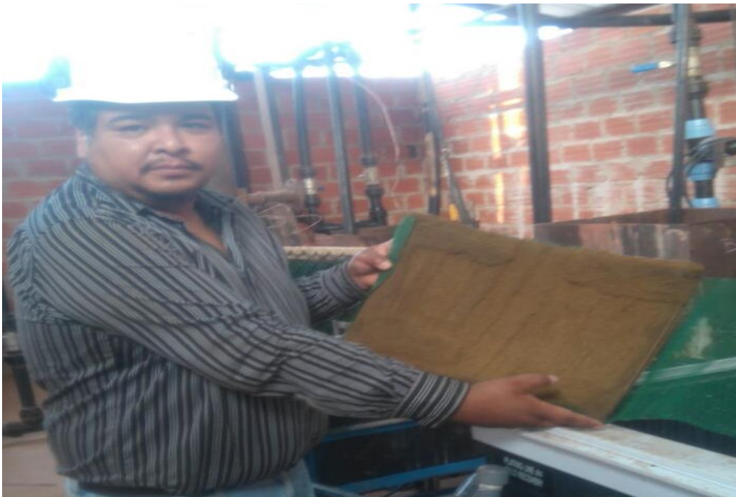
Figura 33. Cosecha de cátodos de oro. Fuente: Elaboración propia.
