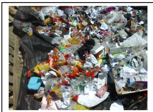
Fig N° 05: homogenización de RRSS
