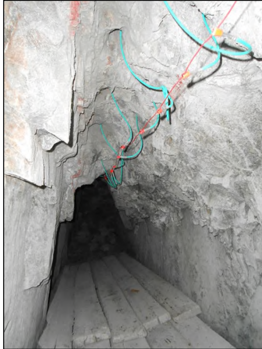
Figura N°19: Carguío, usando carmex y semigelatina
