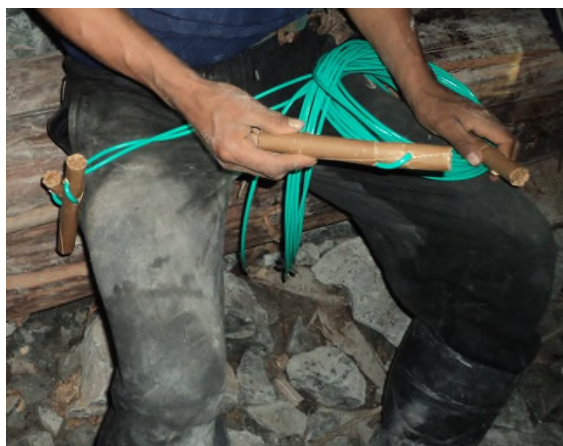
Figura N°20: Carguío, usando carmex y semigelatina
