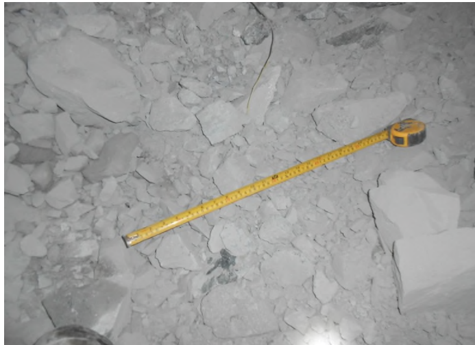
Figura N° 21: Fotografía después de la voladura
