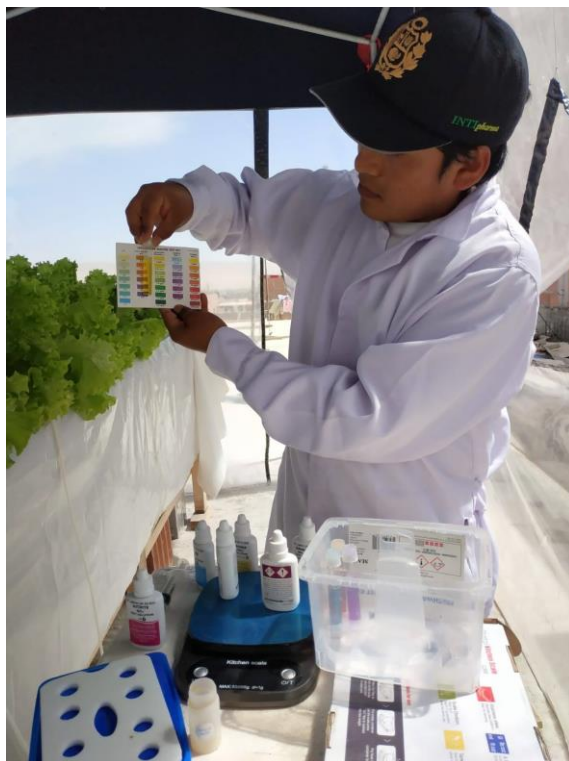
Foto 15: Registro de parámetros fisicoquímicos en el sistema hidropónico
