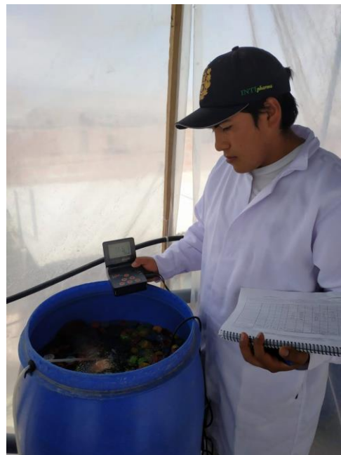
Foto 14: Registro de parámetros fisicoquímicos en el biofiltro
