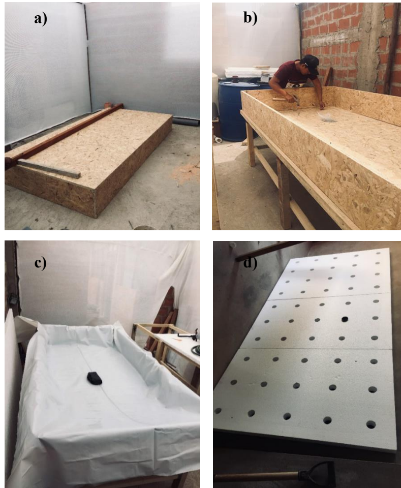
Foto 6: Construcción del sistema hidropónico. a) caja hidropónica de tableros de arcilla. b) construcción del sistema hidropónico. c) Caja hidropónica cubierto con plástico. d) Tecnopor con agujeros.
