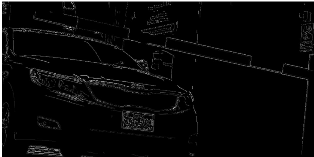
Figura 9. Resultado de aplicar el detector de bordes Canny.
