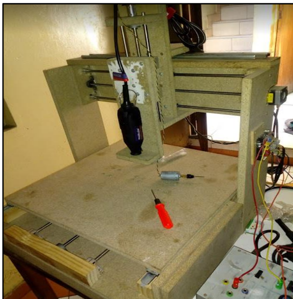
Figura 61. Motor para fresas acoplado a módulo router CNC como herramienta de corte
