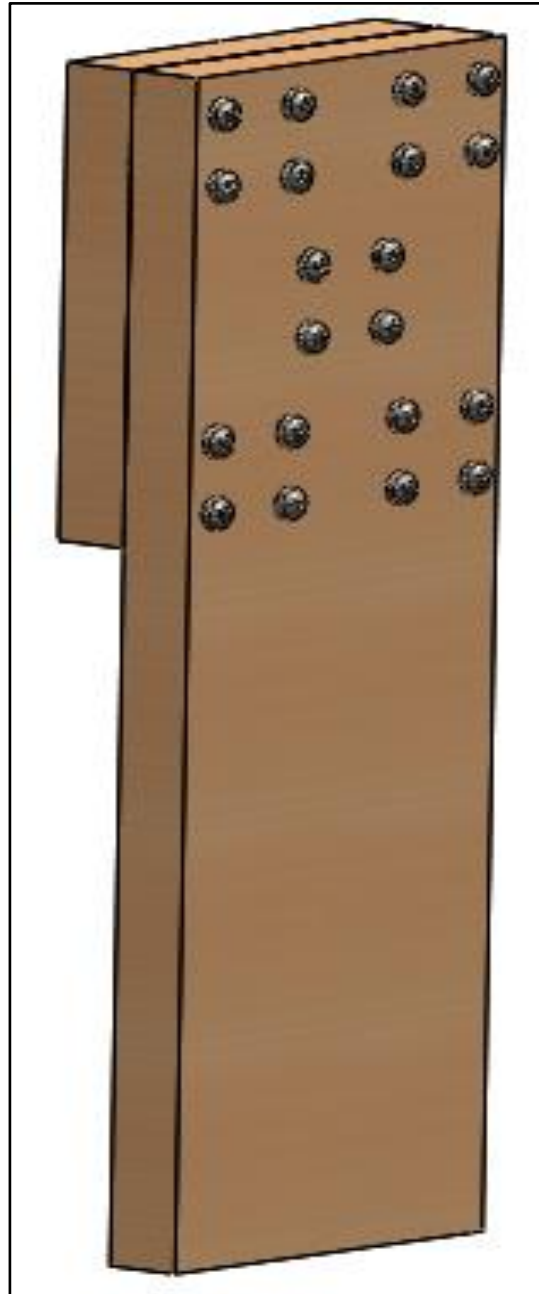
Figura 56. Ensamble de la plataforma Z y subplataforma Z con tornillos de ajuste M4
