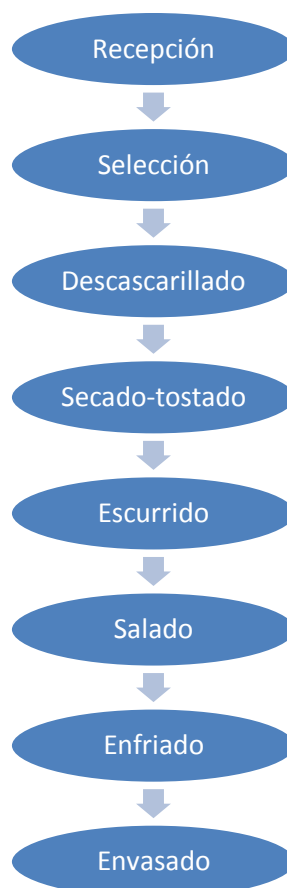
FIGURA N°12: FLUJOGRAMA DE ELABORACIÓN DE LAS SEMILLAS DE SACHA INCHI SECADAS-TOSTADAS
