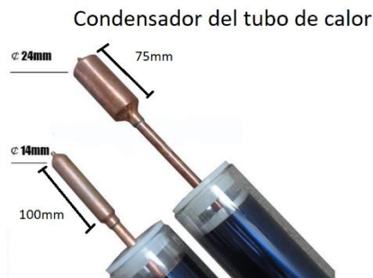
Figura 20. Tubo de vacío con condensador
