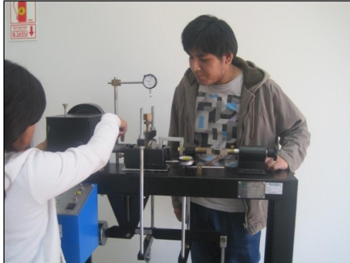
Figura 17. Ejecución del ensayo de corte directo en la UPT de una de las 6 muestras de suelo destinadas a ensayos especiales obtenidas de la zona de estudio
