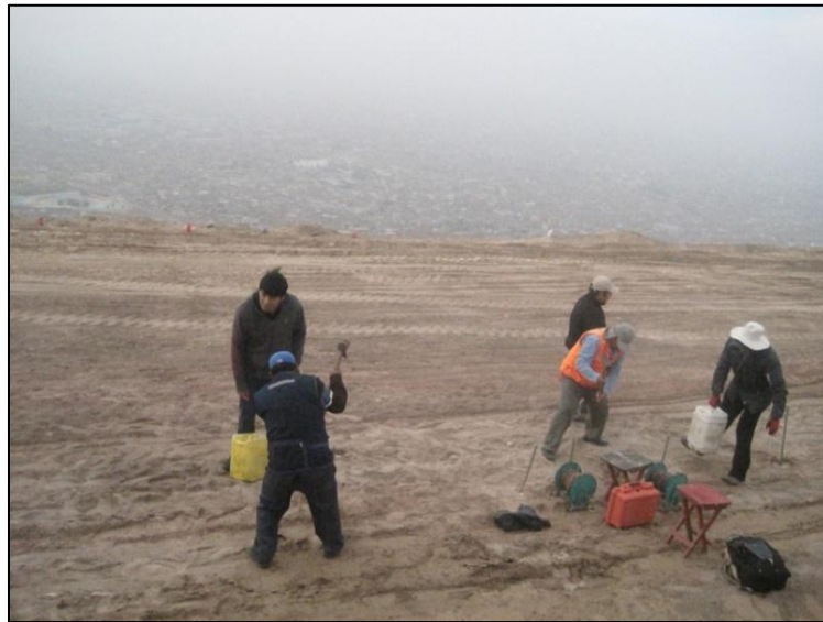
Figura 08. Preparación de los equipos para el sondeo eléctrico vertical en la zona de estudio
