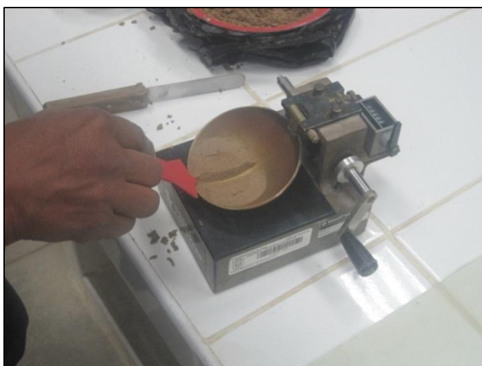
Figura 14. Ejecución del ensayo de límite líquido en el laboratorio de la UPT de una de las 12 muestras de suelo obtenidas en la zona de estudio
