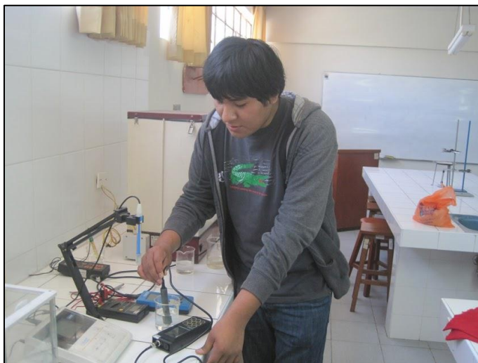
Figura 19. Ejecución del ensayo de sales solubles en el laboratorio de química de la UPT de una de las 12 muestras de suelo obtenidas en la zona de estudio
