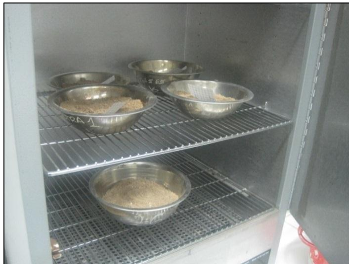
Figura 16. Secado en horno para determinar el contenido de humedad en el laboratorio de la UPT de 4 de las 12 muestras de suelo obtenidas en la zona de estudio
