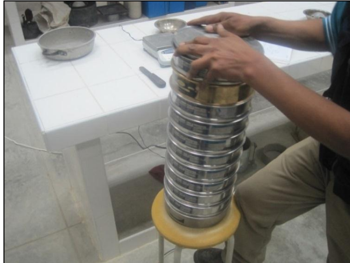
Figura 15. Ejecución del ensayo granulométrico por tamizado en el laboratorio de la UPT de una de las 12 muestras de suelo obtenidas en la zona de estudio
