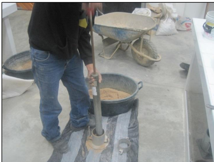
Figura 13. Ejecución del ensayo de proctor modificado en el laboratorio de la UPT de una de las 12 muestras de suelo obtenidas en la zona de estudio
