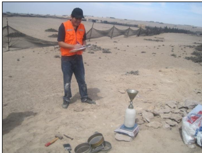
Figura 12. Preparación de los equipos para obtener la densidad de campo y humedad natural en una de las 12 calicatas de la zona de estudio
