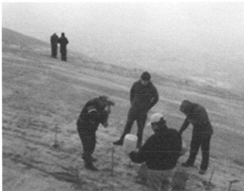
Foto N° 02.- Técnicos realizando la configuración tetraeléctrica del SEV. N°01 para empezar la lecturas del subsuelo, al fondo se aprecia la ciudad de Tacna.
