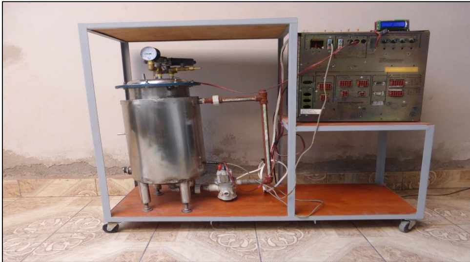
Figura 88. Módulo de control difuso de temperatura en el biodigestor.
