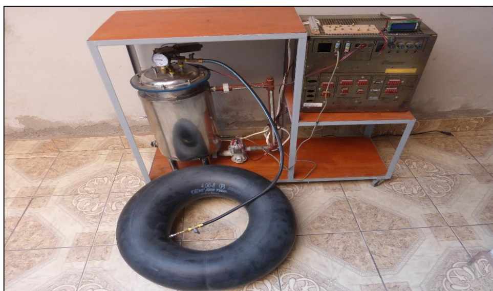
Figura 93. Extracción y almacenamiento del biogás del biodigestor.
