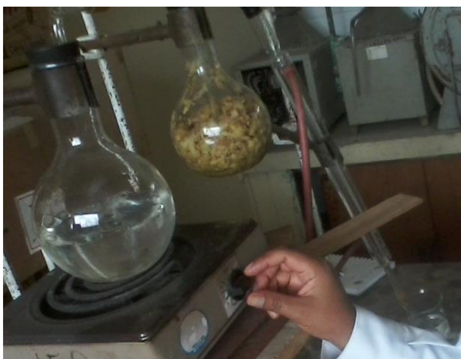
Figura 9. Extracción del aceite esencial del jengibre Fuente: elaboración propia (2016)
