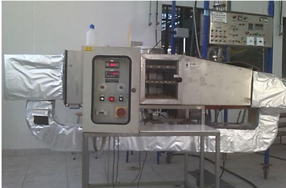
Figura 7. Equipo secador adaptado con línea de recirculación de aire caliente
