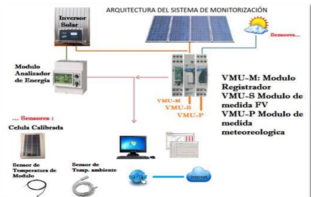
Figura 26: Diagrama de instalación de monitoreo del SFCR en el CERT Fuente: (Sunco, 2015)
