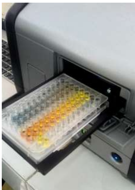
ANEXO 21. Fotografía de la medición de curvas de calibración con lector de placa
