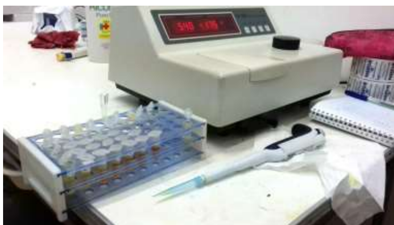
ANEXO 22. Fotografía del espectrofotómetro para medir las absorbancias de actividad enzimática
