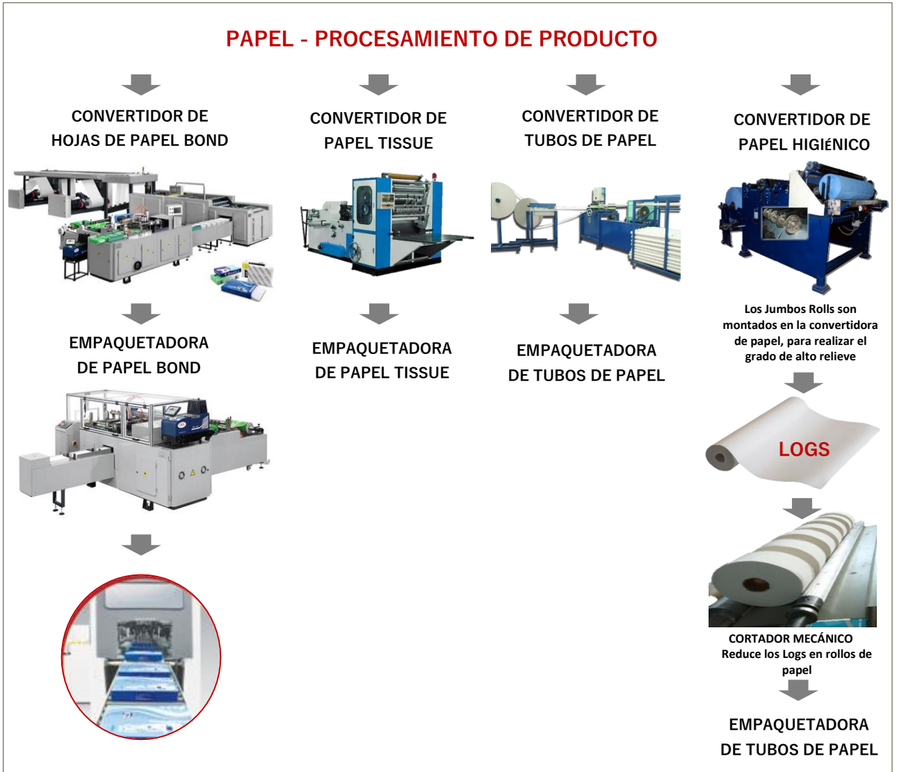
Figura 63 Esquema de máquinas para el Proceso de fabricación de producto nuevo - PAPEL
