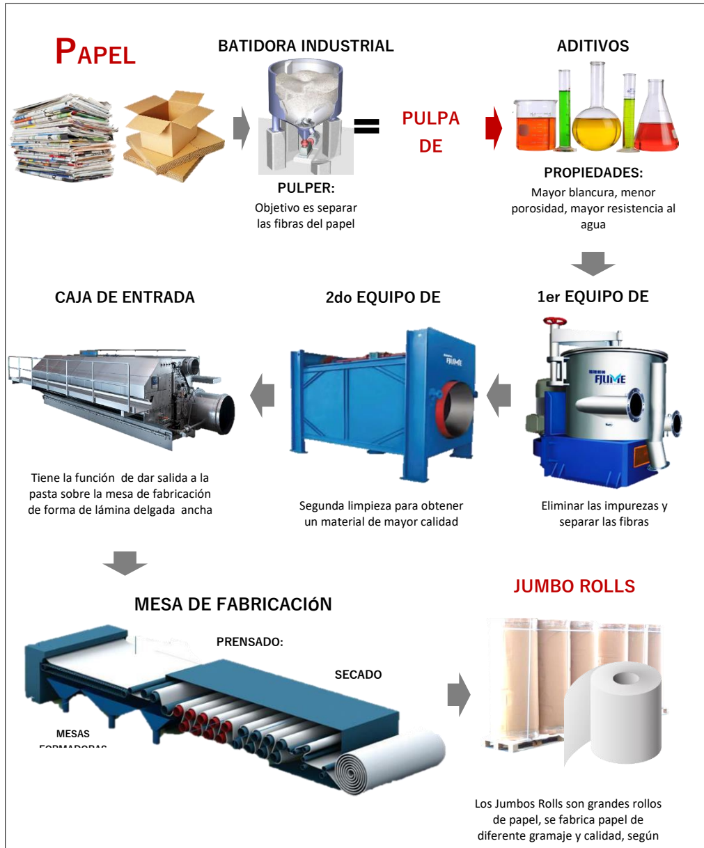
Figura 62 Esquema de máquinas para el Proceso de transformación del papel
