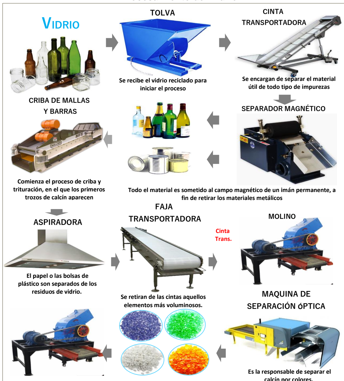
Figura 64 Esquema de máquinas para el Proceso de transformación del vidrio reciclado
