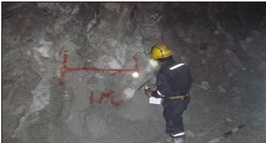
Figura 19. Marcado del hastial de 1 metro lineal Fuente: Elaboración propia.
