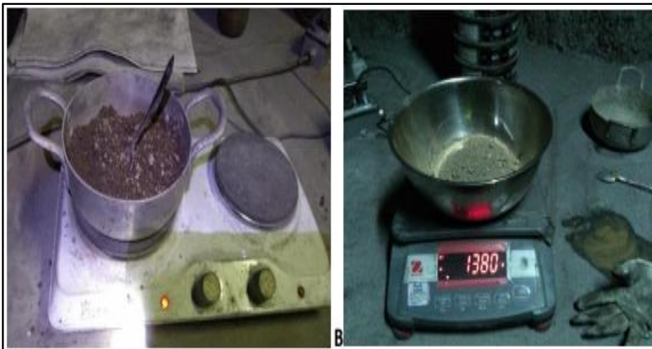
Figura 29. Cálculo de humedad del agregado Fuente: Elaboración propia.
