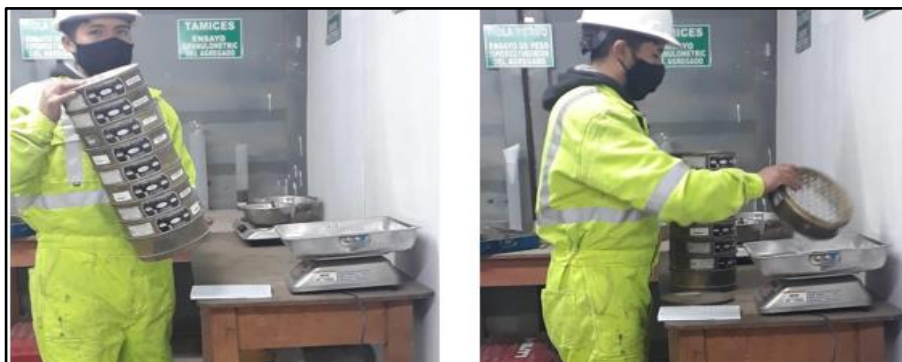
Figura 33. Ensayo de granulometría del agregado Fuente: Elaboración propia.
