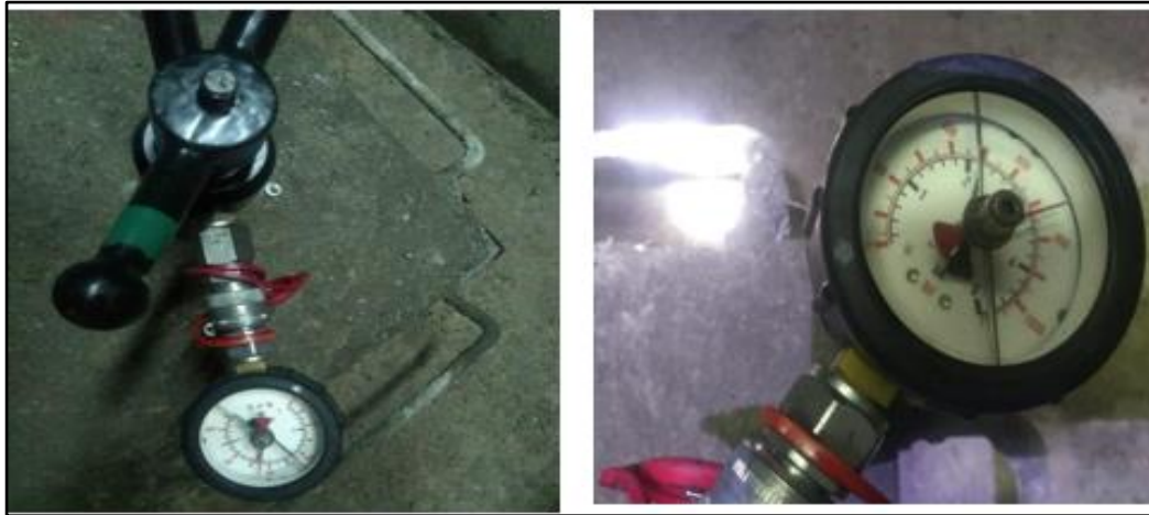
Figura 51. Ensayo de resistencias a edades tempranas del shotcrete Fuente: Elaboración propia.
