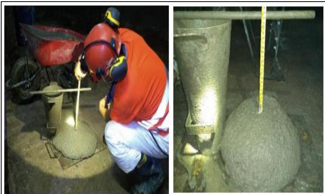
Figura 44. Ensayo de slump en labor Fuente: Elaboración propia.
