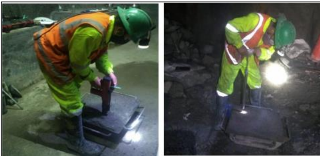
Figura 50. Ensayo de resistencias a edades tempranas del shotcrete Fuente: Elaboración propia.
