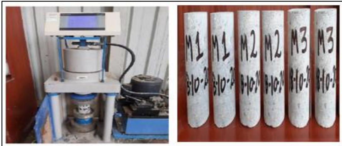
Figura 59. Probetas para el ensayo de resistencia a la compresión Fuente: Elaboración propia.
