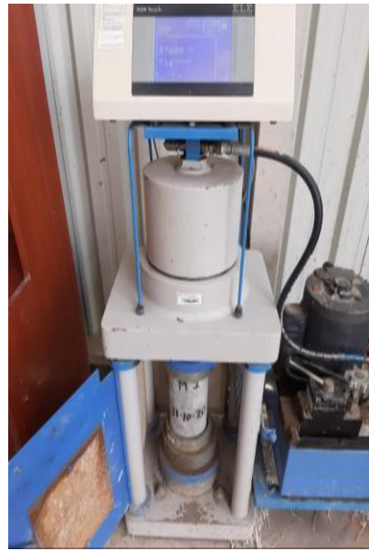
Figura 55. Ensayos de probetas para la resistencia a compresión Fuente: Elaboración propia.
