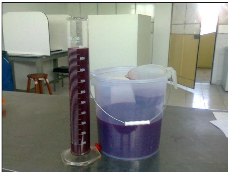
Figura 18. Medida en grados Baumé y demás análisis en una muestra extraída durante la fermentación.
