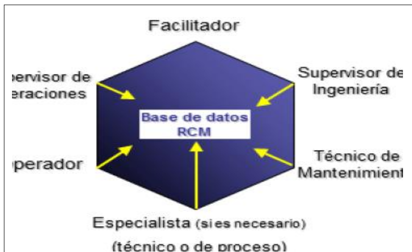
Figura 43. Equipos de revisión RCM
