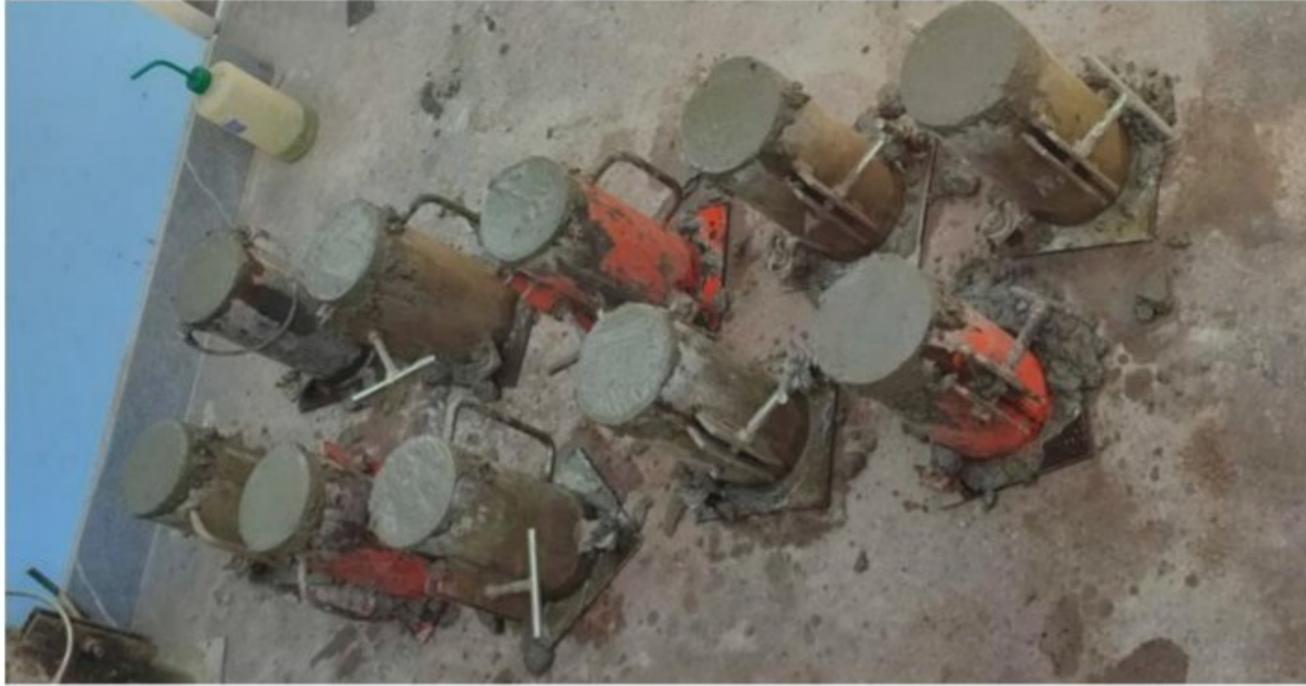
Figura 10. Elaboración de testigos de concreto en estado fresco
