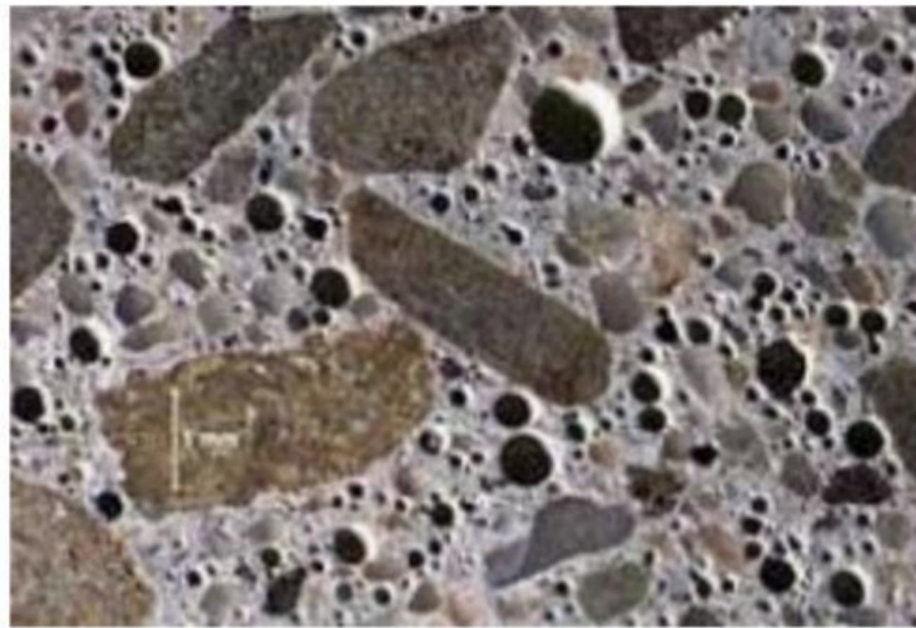
Figura 01: acercamiento de un concreto con aire incorporado
