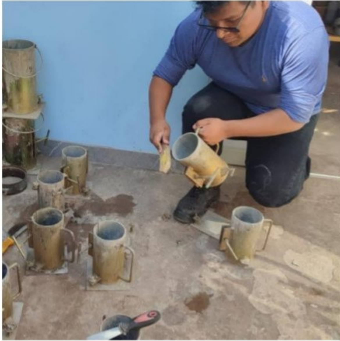
Figura 08. Limpieza manual de moldes de testigo de concreto
