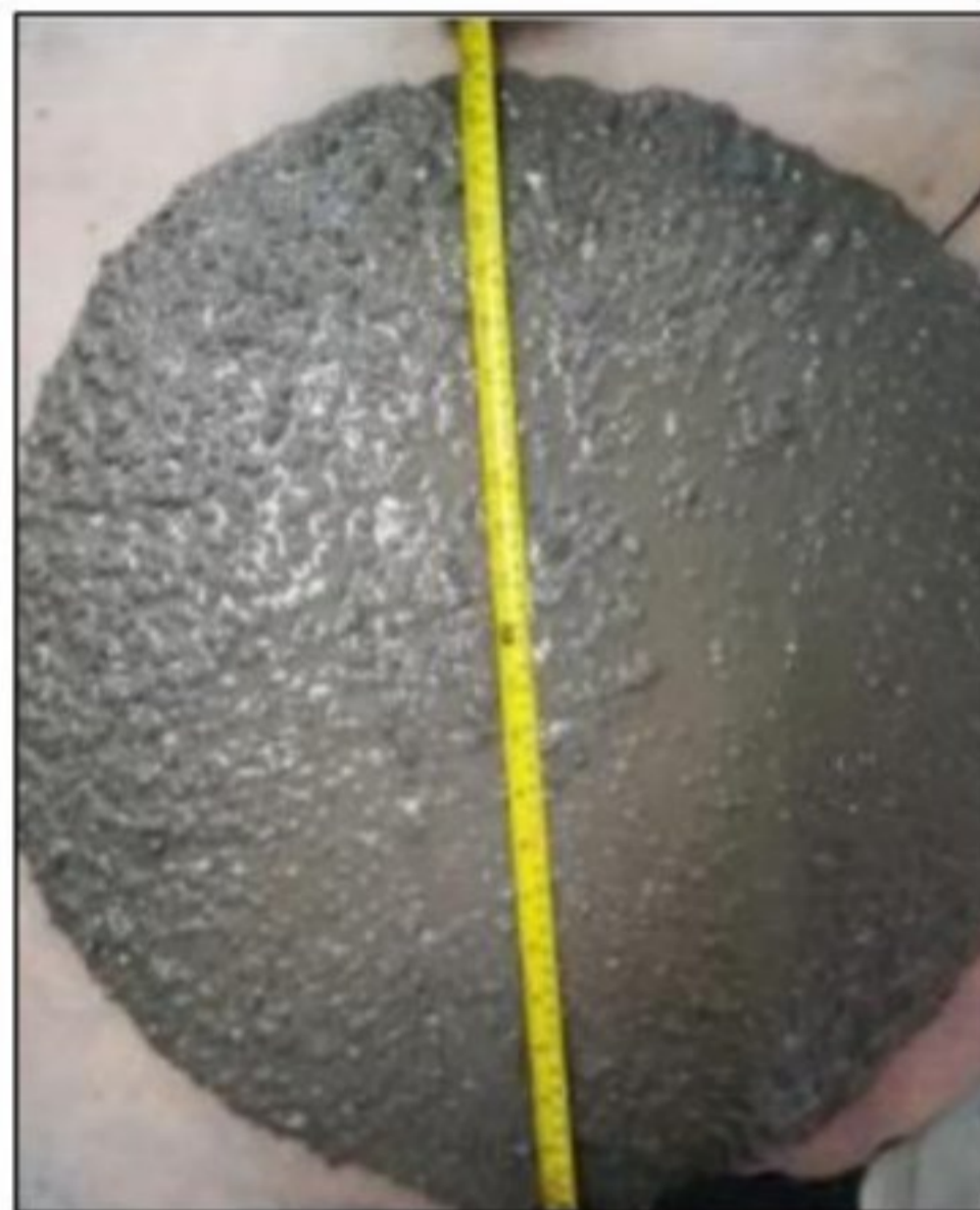
Figura 03: Ensayo de Slump Flow en concreto autocompactante Fuente: (Palencia, 2020)
