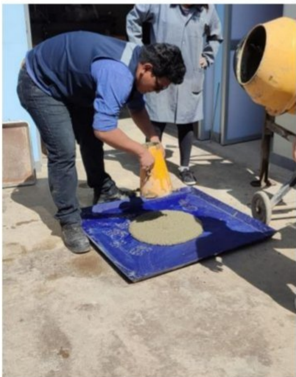
Figura 05. Fotografía de ensayo de revenimiento realizado (proceso)
