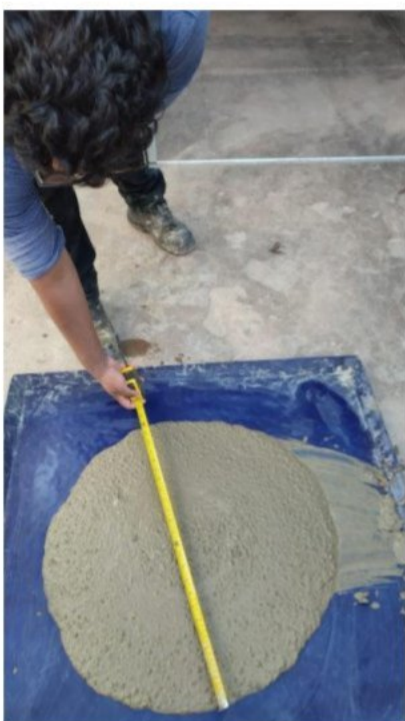
Figura 04. Fotografía de ensayo de revenimiento realizado (resultado)
