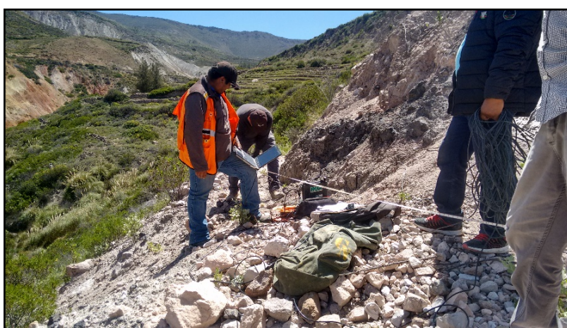
Figura 40: Ensayo de MASW, conexión de geófonos cada 3 metros para el ensayo de MASW.
