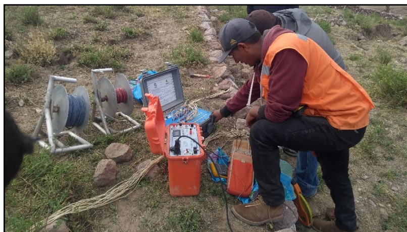
Figura 41: Prospección geofísica con método de Tomografía Eléctrica.
