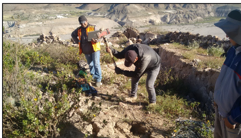
Figura 39: refracción sísmica, origen de ondas primarias a través de un tiro, luego son registrados en cada geófono.
