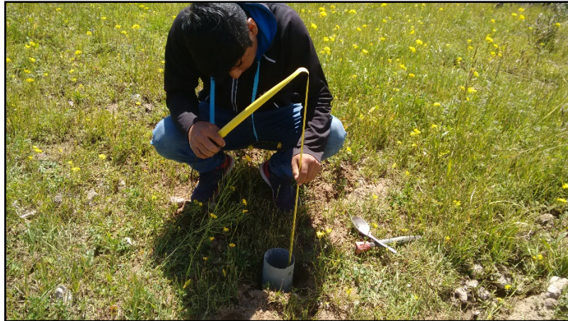
Figura 43: Ensayo de permeabilidad in situ (método porchet).
