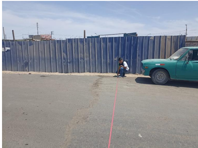
Medición del ancho de carriles en la Avenida Municipal (Estación 4)
