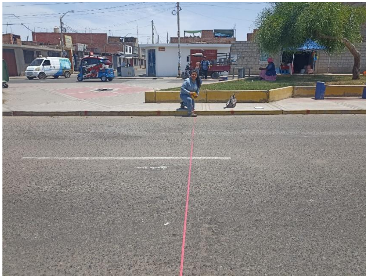
Medición del ancho de carriles en la Avenida Municipal (Estación 2)
