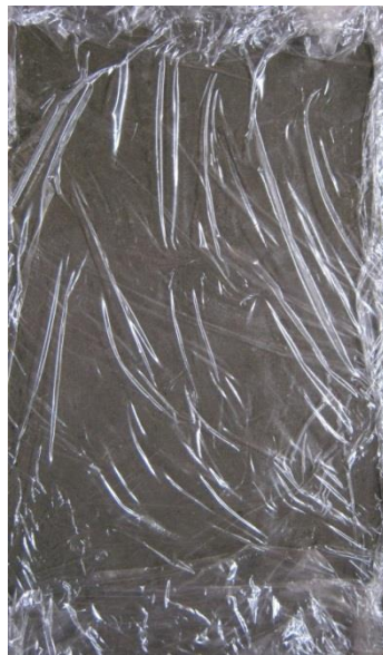
Figura 8: Vista fotográfica como la probeta es fraguada.
