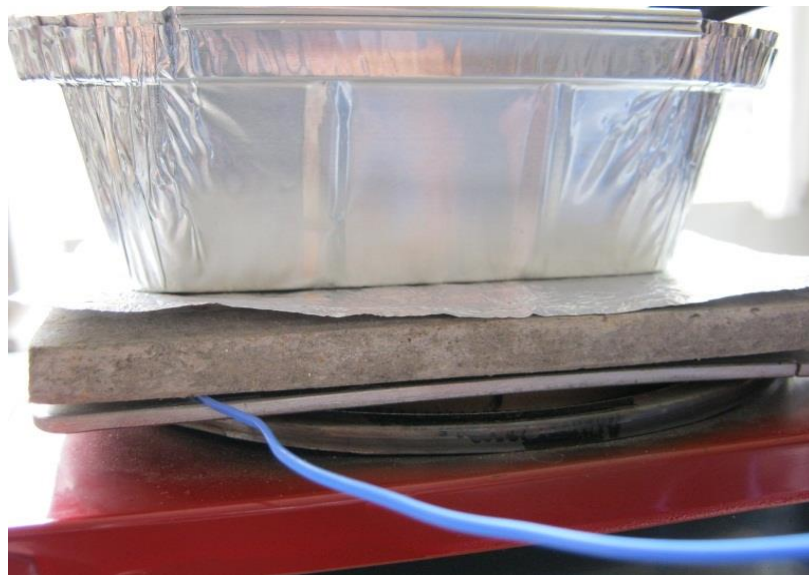
Figura 10: Vista fotográfica del ensayo de Conductividad Térmica.
