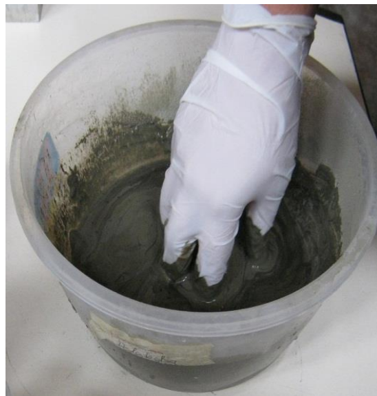
Figura 5: Vista fotográfica de la mezcla del cemento –papel reciclado.
