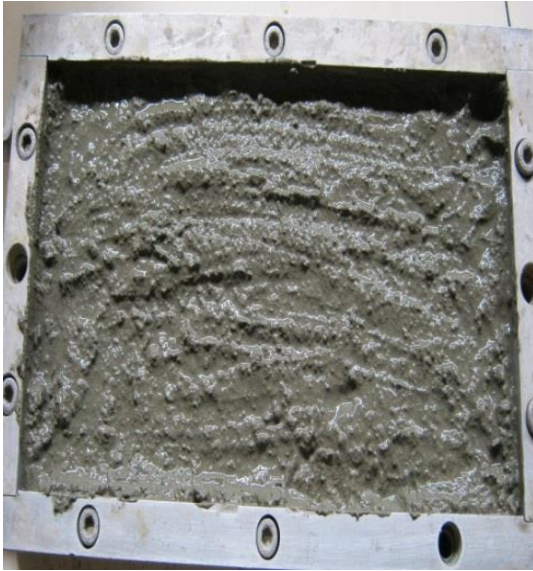
Figura 6: Vista fotográfica de la mezcla en el molde.
