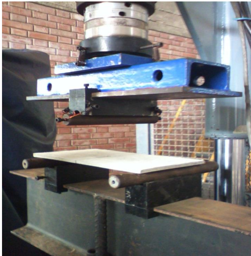
Figura 9: Vista fotográfica del ensayo de Flexión.
