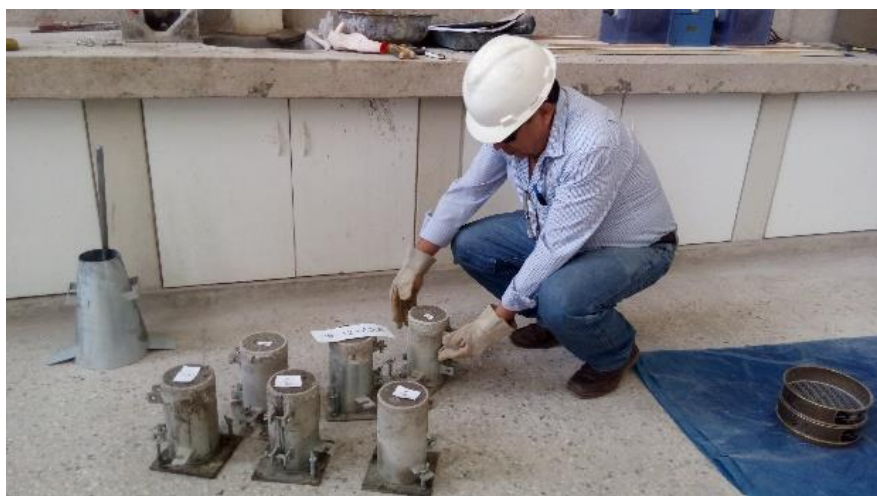
Figura 45. Colocación en moldes para probetas de 4 x 8 pulgadas.
