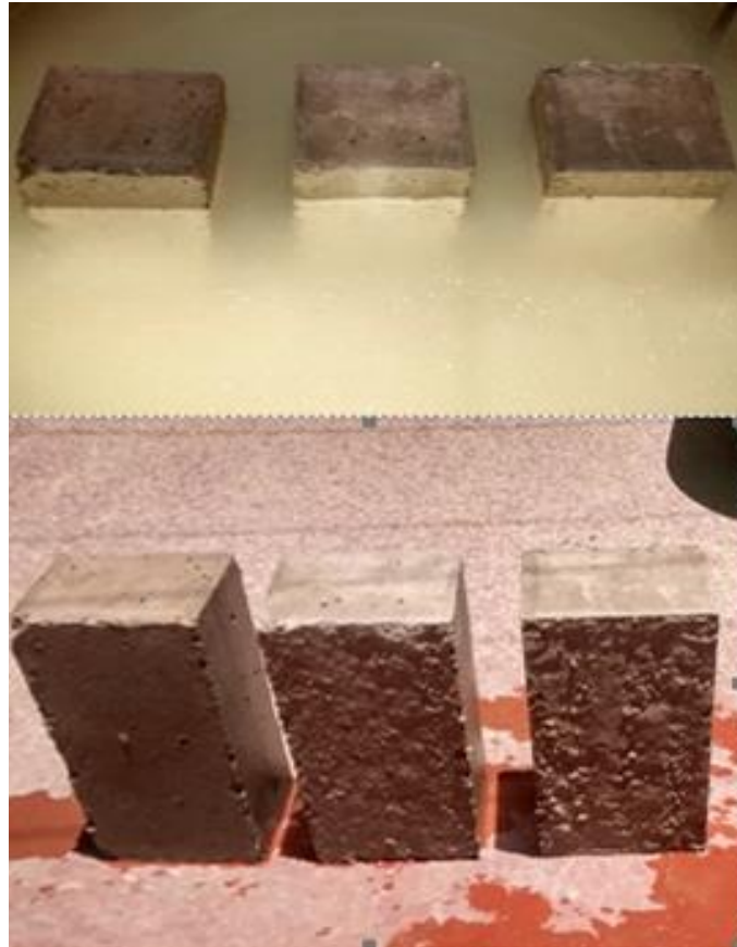
Figura 47. Bloques de concreto con 10 % PET.
