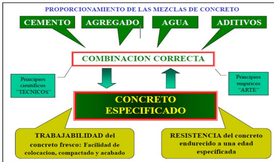
Figura 34. Proceso general para obtención de concreto especificado Fuente: (Vizconde, 2017).
