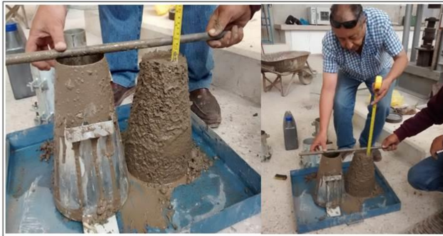
Figura 44. Prueba de Slump y trabajabilidad de concreto.
