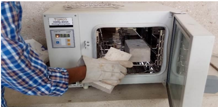
Figura 49. Prueba de horno para determinar humedad de bloque
