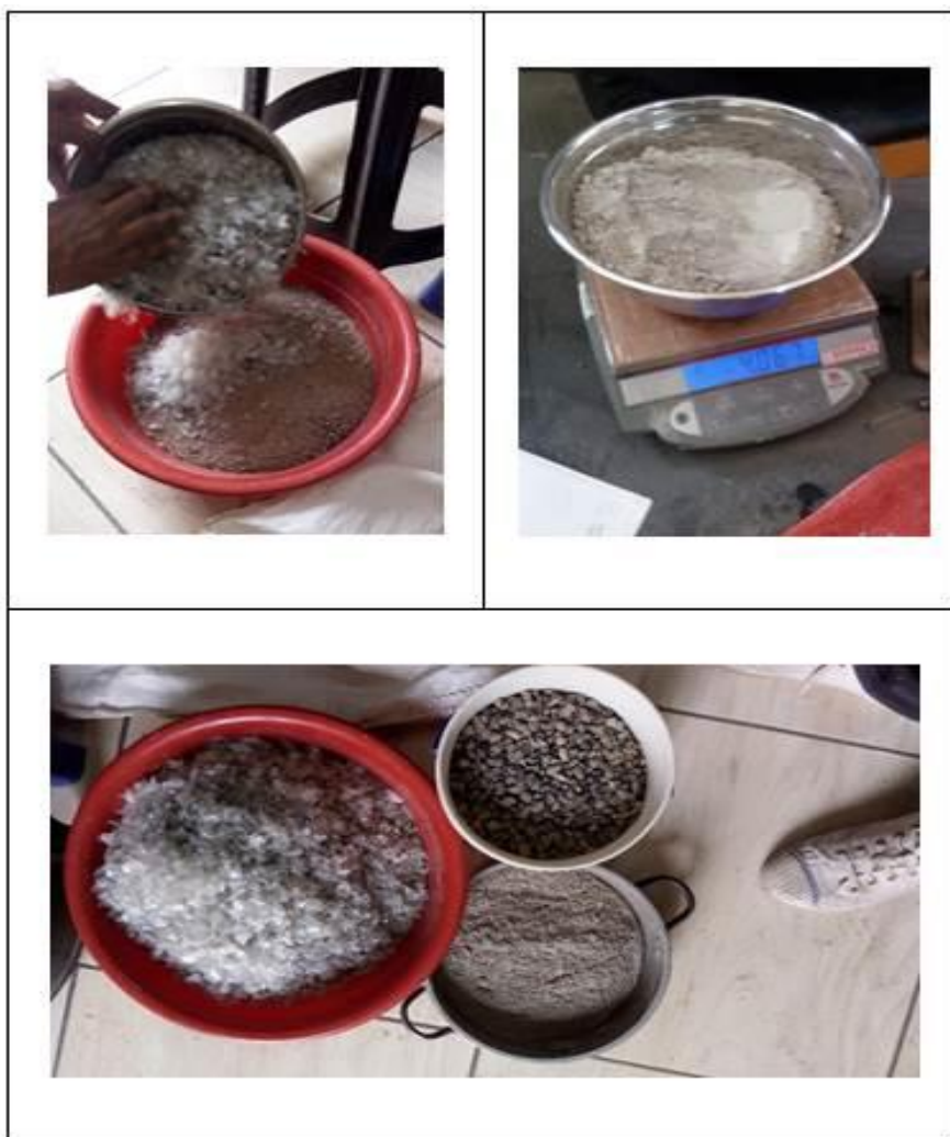
Figura 39. Proceso de dosificación de mezclas con adición de PET
