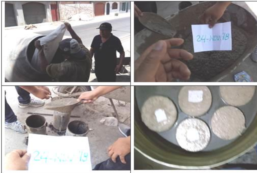
Figura 40. Preparacion de mezcla y elaboracion de las probetas.
