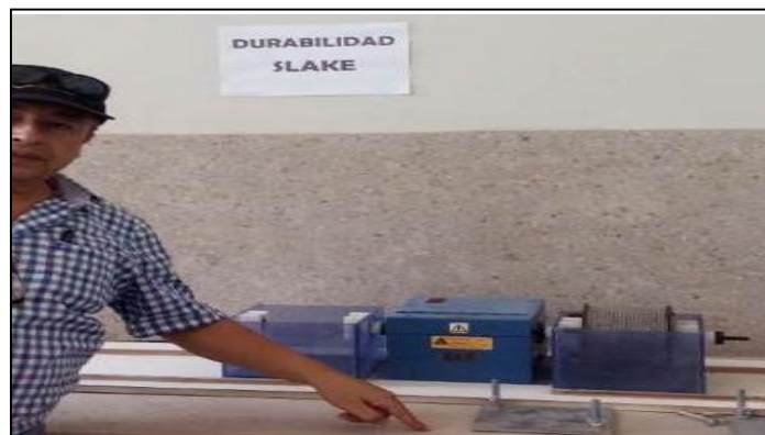
Figura 51. Equipos para determinar durabilidad de bloques
