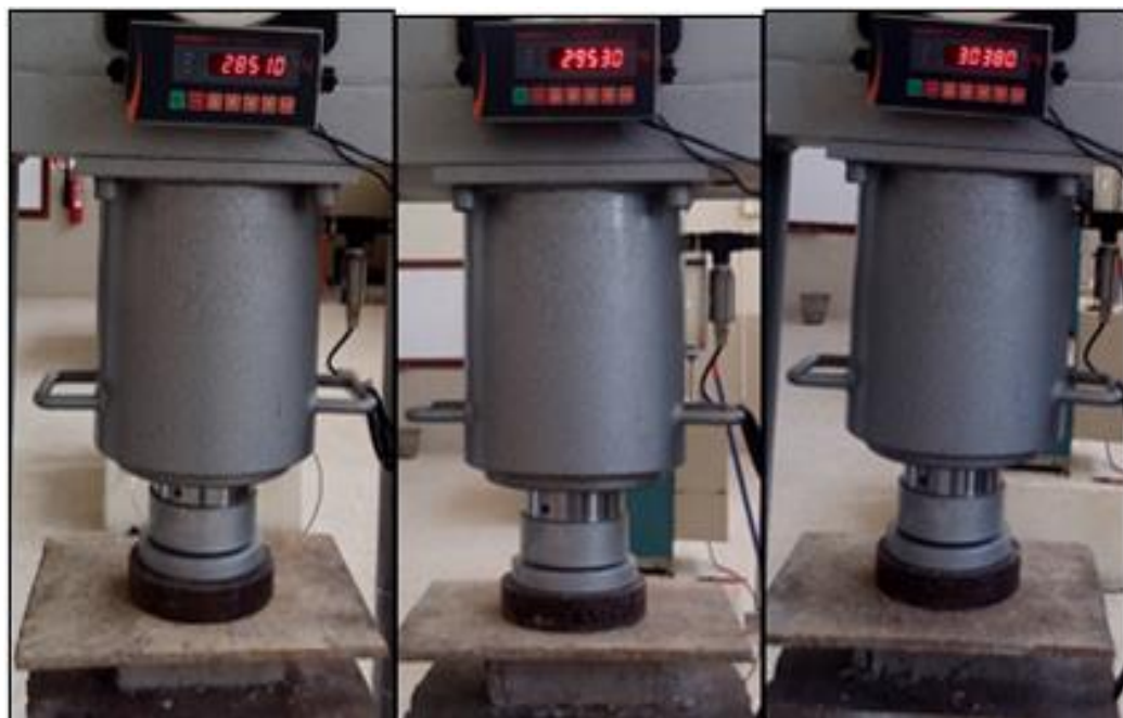
Figura 48. Lectura de la resistencia a la compresión de los bloques con 10% de PET a los 30 días.
