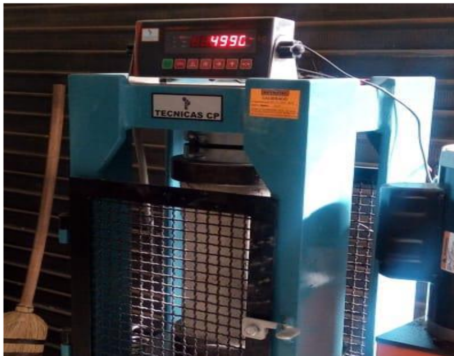
Figura 41. Resultante de Prueba de compresión en kg-F (28 días).
