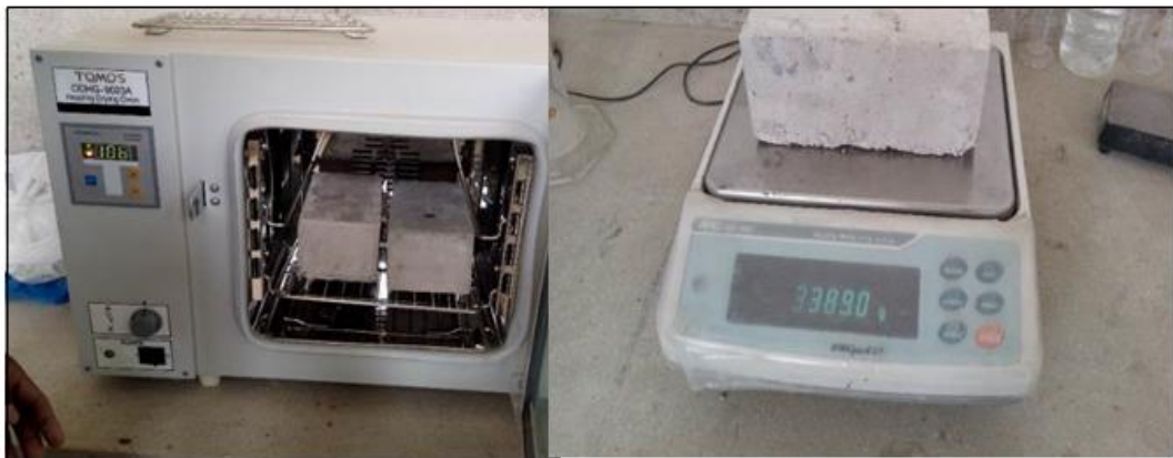
Figura 50. Proceso para determinar grado de absorción en bloques Fuente: Elaboración propia.
