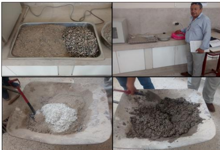
Figura 46. Dosificación y mezclado en ensayo 3 (manual)
