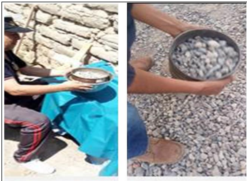
Figura 36. Clasificación y análisis granulométrico del agregado.
