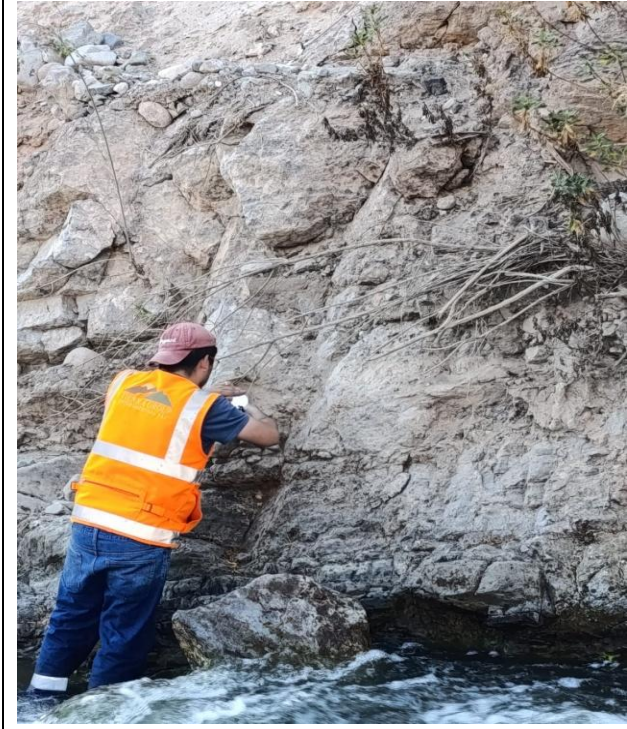
Foto N°1.- Levantamiento de discontinuidades y puntos de control
