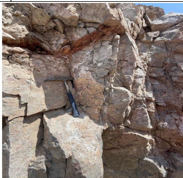
Foto N°7.- Identificación de venillas de calcita en mapeo de talud
