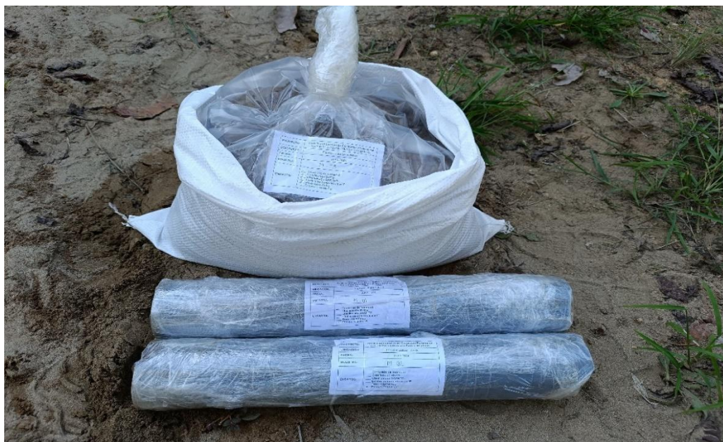
Fotografía 3. Muestras de suelo obtenidas de calicatas para ensayos de laboratorio.
