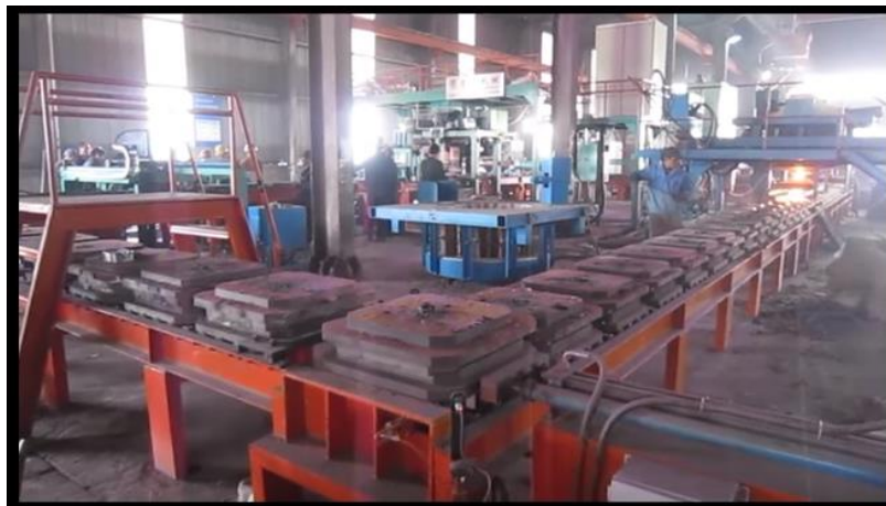
Figura 9. Máquina de colada continua de bolas fundidas Fuente: Máquina de colada continua BINJACORPSA (2018)
