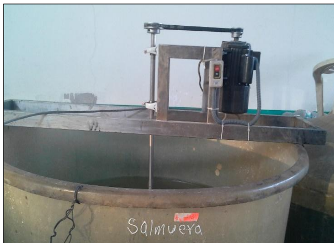
Figura 21. Agitación mediante equipo de agitación
