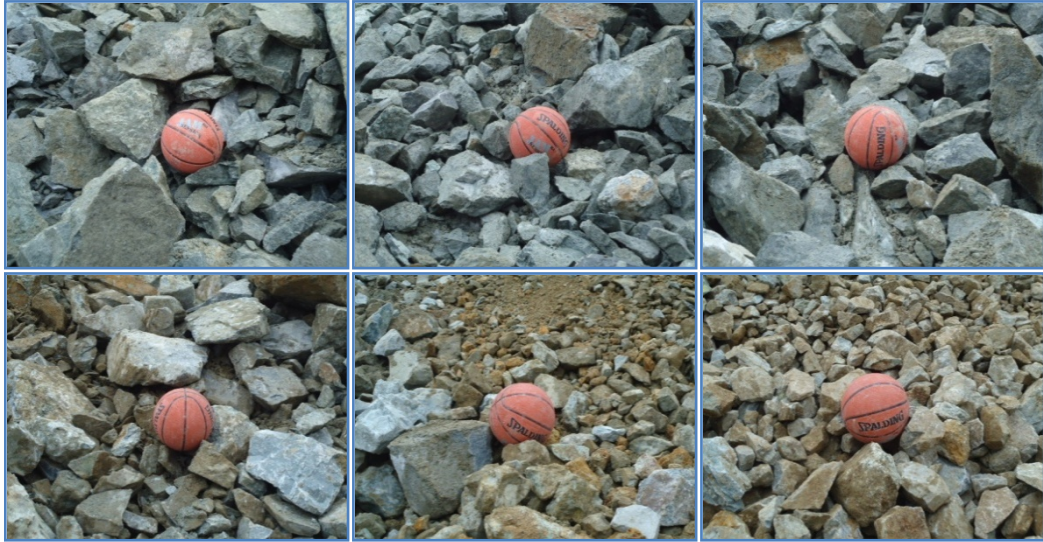
Figura N° 4.21: Fragmentación en prueba de Heavy Anfo 55 con mezcla.
