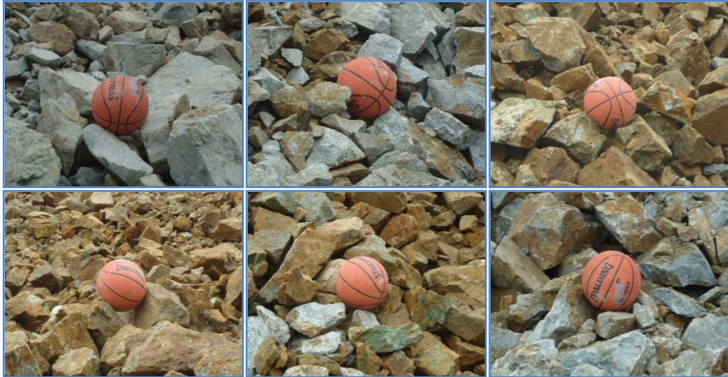
Figura N° 4.23: Fragmentación en prueba de Heavy Anfo 64 con mezcla.
