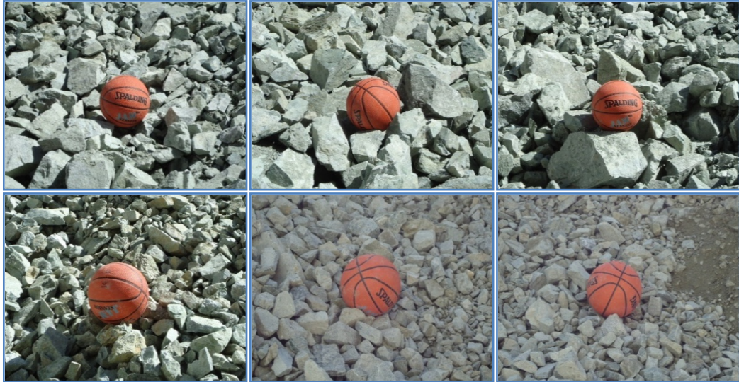
Figura N° 4.19: Fragmentación en prueba de Heavy Anfo 46 con mezcla.
