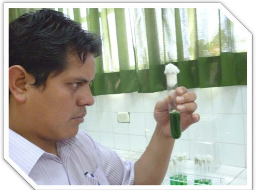
Foto 20: verificación de presencia o ausencia de gas.
