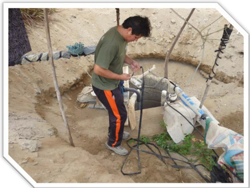
Foto 12: Toma de muestra con cordel en pozos abiertos
