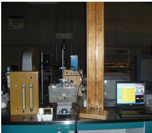
Sistema de análisis de la capacidad de absorción de CO 2 de aminas en el laboratorio. (Fuente: Propia).
