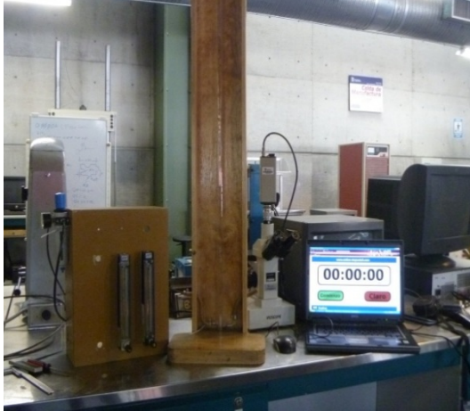
Calibrando el rotámetro. (Fuente: Propia).
