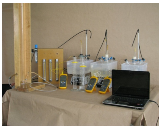
Sistema propuesto para determinar la capacidad de absorción de aminas en biogás (Fuente: Proyecto MOPESA).
