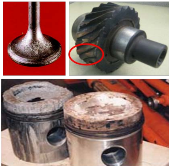
Figura 4: Efectos del H_2S . Asientos de válvulas, engrane de bronce y cabezas de pistón atacadas por H_2S . Fuente: Huertas et al, (2010).
