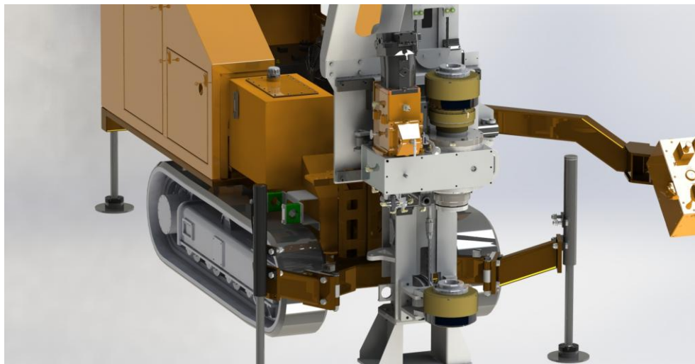
FIGURA N° 16 Equipo de perforación rotativo (diamantina)
