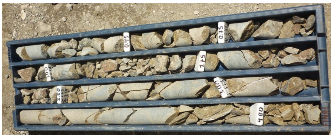
FIGURA N° 32 La extracción de la muestra en el sondeo PE-1 (Prog. 0+000) hasta una profundidad de 4 metros
