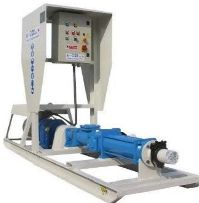
FIGURA N° 17 Bomba de inyecciones para lechada de cemento
