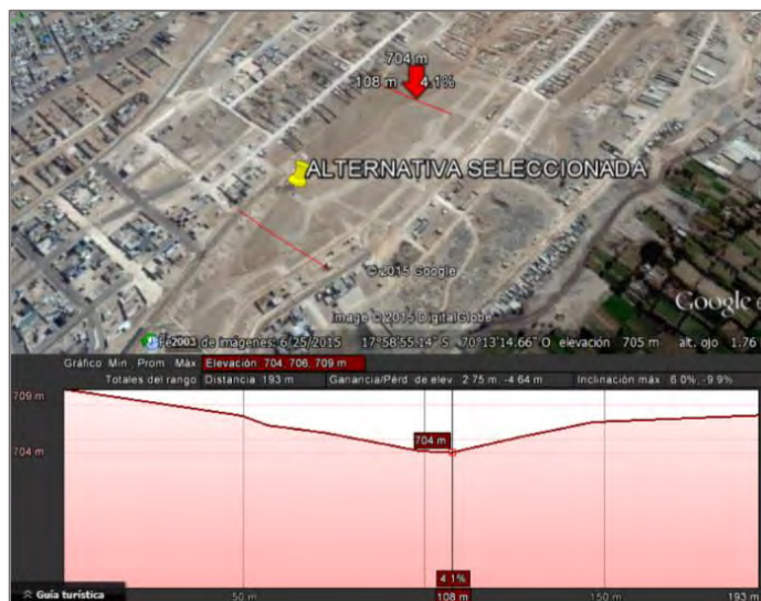
Ilustración N° 24: Sección de corte transversal de terreno.
