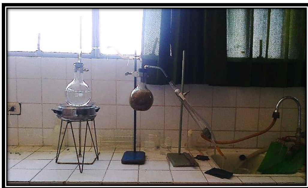
FOTO 09, 10 y 11: Extracción del aceite esencial de Pimpinella anisum L. “anís” por el método de destilación por arrastre de vapor de agua.
