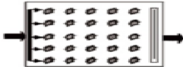
Figura 34. Configuración de distribución de ingreso y salida del humedal y biojardín. Tubería principal con múltiples salidas y tuberías de pie en zanja rellena de grava con única tubería de salida.
