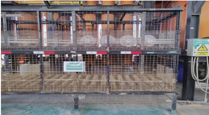
Mesa de Rodillo donde se lleva a cabo la prueba de botellas
