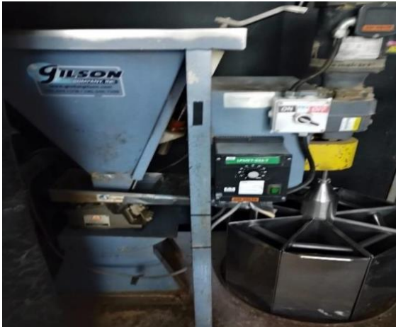
Cuarteador Gilson para sacar las muestras en botellas
