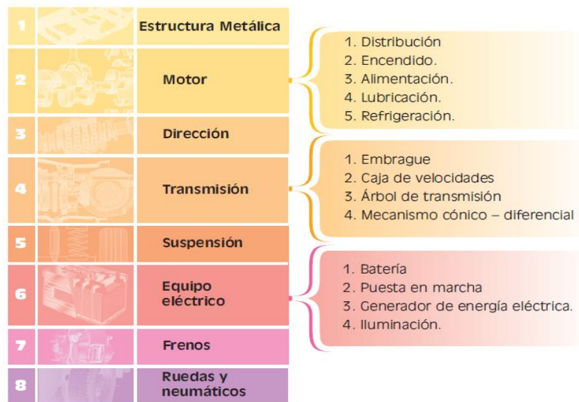
Figura 21. Sistemas y subsistemas de una camioneta.
