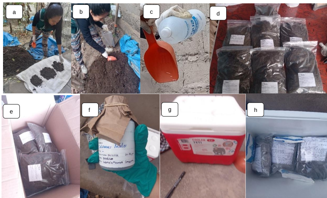
Fotografía 15. Toma de muestra de cada unidad de compost
