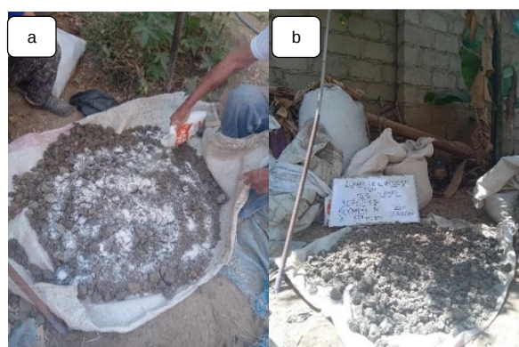
Fotografía 6. Adición de cal viva a lodos residuales
