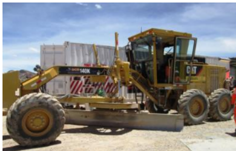
Figura 31. Motoniveladora 140K Fuente: Flota de equipos DCR.
