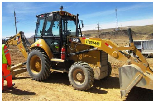
Figura 33. Retroexcavadora 420F Fuente: Flota de equipos DCR.
