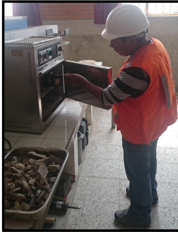
FOTO 05: Ensayo de contenido de humedad
