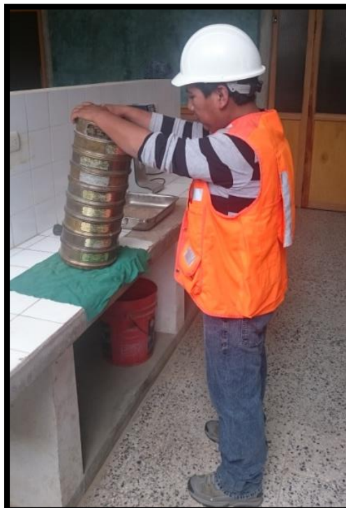
FOTO 06: Ensayo de granulometría.
