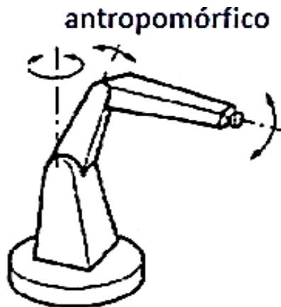
Figura 46 Robot antropomórfico que define el tipo de morfología.
