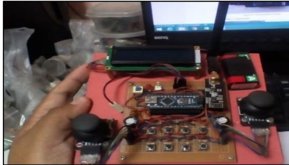
Figura 42 Control inalámbrico a distancia con la antena (NRF24L01).
