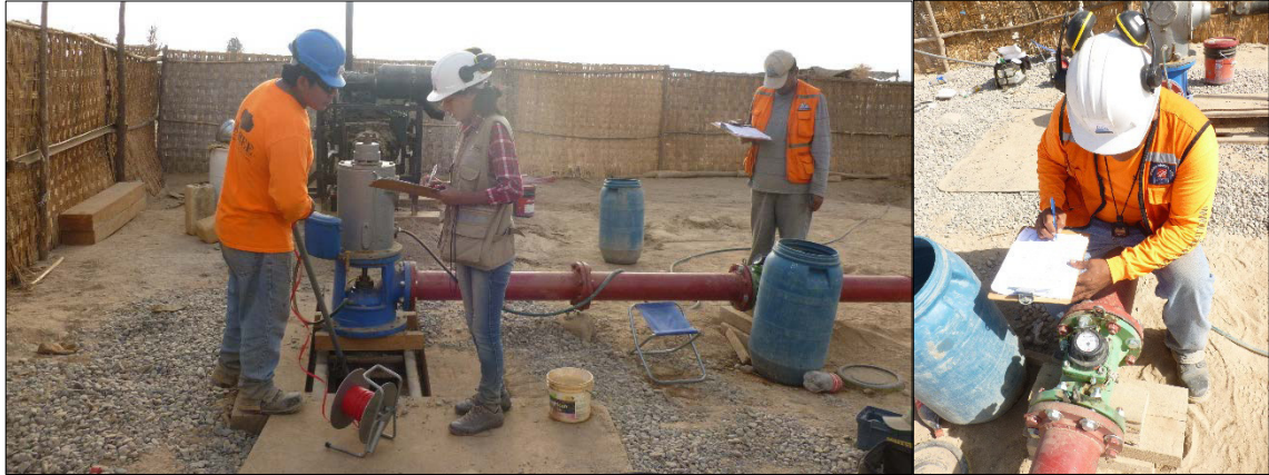
Foto 35 y 36: Medición de niveles de descenso en el pozo Campo Verde de la Asoc. Campo Verde (Coordenadas UTM WGS-84: 345386 Este y 7994275 Norte) y medición de caudales por caudalímetro, mediante el uso de un cronómetro.
