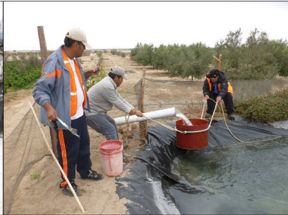
Foto 19 y 20: Medición de niveles de descenso en el pozo El Olivar de la Asoc. Juventud los Olivos (Coordenadas UTM WGS-84: 351737 Este y 7990463 Norte) y medición de caudales por el método volumétrico, mediante un cilindro calibrado y un cronómetro.
