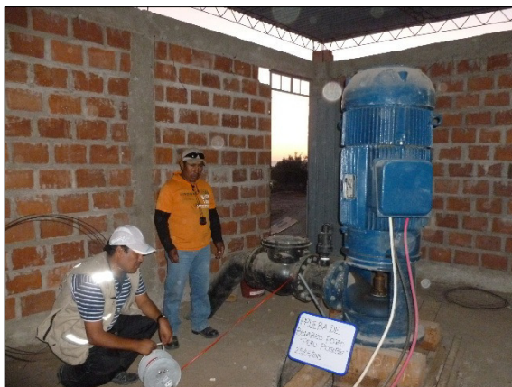
Foto 21 y 22: Medición de niveles de descenso en el pozo N°02 de la Asoc. Perú Posible (Coordenadas UTM WGS-84: 349275 Este y 7984546 Norte) y medición de caudales por el método volumétrico, mediante el uso de un cilindro calibrado y un cronómetro.
