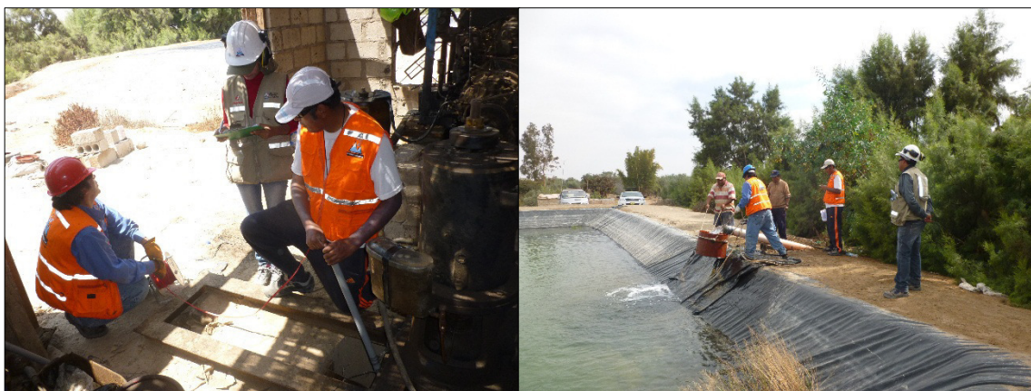
Foto 33 y 34: Medición de niveles de descenso en el pozo ELIM-01 de la Asoc. ELIM (Coordenadas UTM WGS-84: 348888 Este y 7986577 Norte) y medición de caudales por el método volumétrico, mediante el uso de un cilindro calibrado y un cronómetro.
