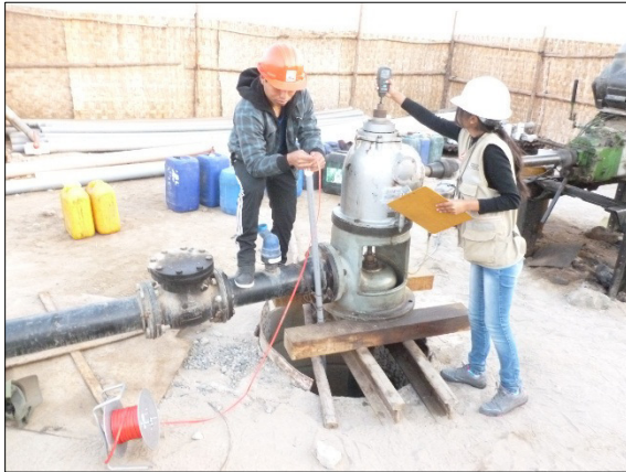
Foto 19 y 20: Medición de niveles de descenso en el pozo El Olivar de la Asoc. Juventud los Olivos (Coordenadas UTM WGS-84: 351737 Este y 7990463 Norte) y medición de caudales por el método volumétrico, mediante un cilindro calibrado y un cronómetro.
