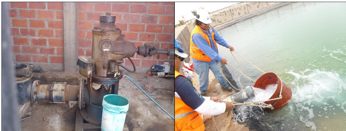
Foto 7 y 8: Medición de niveles de descenso en el pozo IRHS-263 (Coordenadas UTM WGS-84: 353567 Este y 7987260 Norte) y medición de caudales por el método volumétrico, mediante el uso de un cilindro calibrado y un cronómetro.
