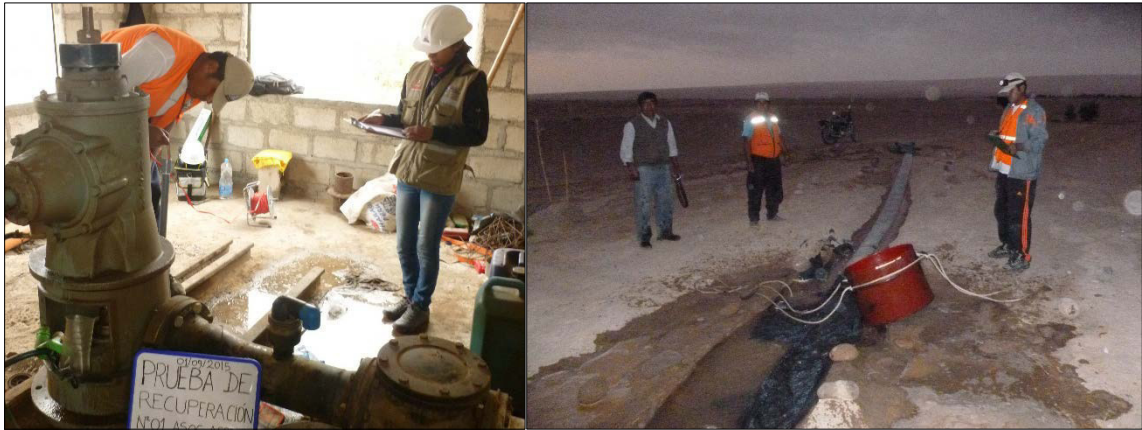
Foto 25 y 26: Medición de niveles de descenso en el pozo N°01 de la Asoc. Tierra Prometida (Coordenadas UTM WGS-84: 346517 Este y 7997139 Norte) y medición de caudales por el método volumétrico, mediante un cilindro calibrado y un cronómetro.
