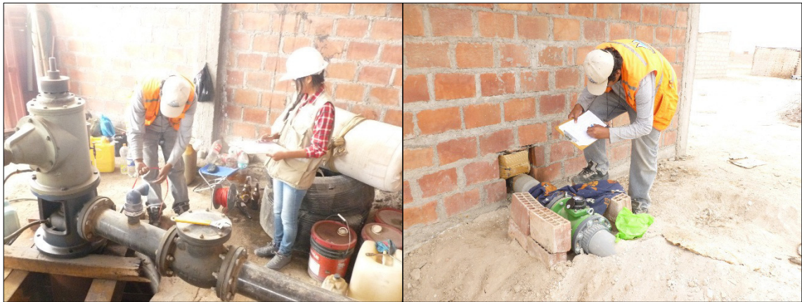
Foto 37 y 38: Medición de niveles de descenso en el pozo N°01 de la Asoc. San Juan (Coordenadas UTM WGS-84: 340300 Este y 7991664 Norte.) y medición de caudales por caudalímetro, mediante el uso de un cronómetro.
