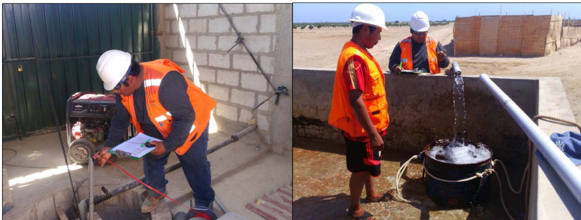
Foto 31 y 32: Medición de niveles de descenso en el pozo Tito Chocano de la Asoc. Vivienda Nueva Generación Tito Chocano (Coordenadas UTM WGS-84: 350547 Este y 7986527 Norte) y medición de caudales por el método volumétrico, mediante el uso de un cilindro calibrado y un cronómetro.
