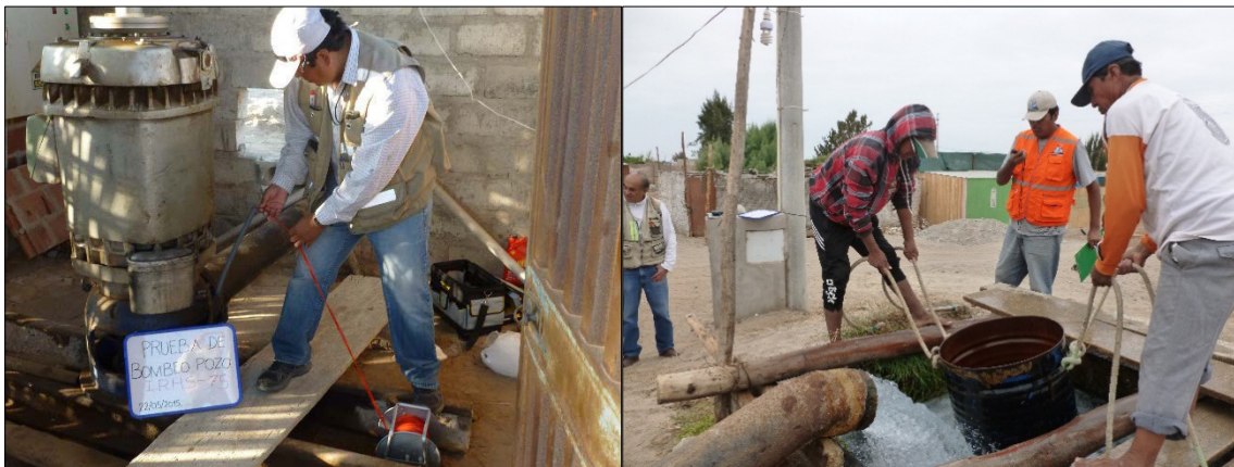
Foto 3 y 4: Medición de niveles de descenso en el pozo IRHS-075 (Coordenadas UTM WGS-84: 348726 Este y 7983708 Norte) y medición de caudales por el método volumétrico, mediante el uso de un cilindro calibrado y un cronómetro.
