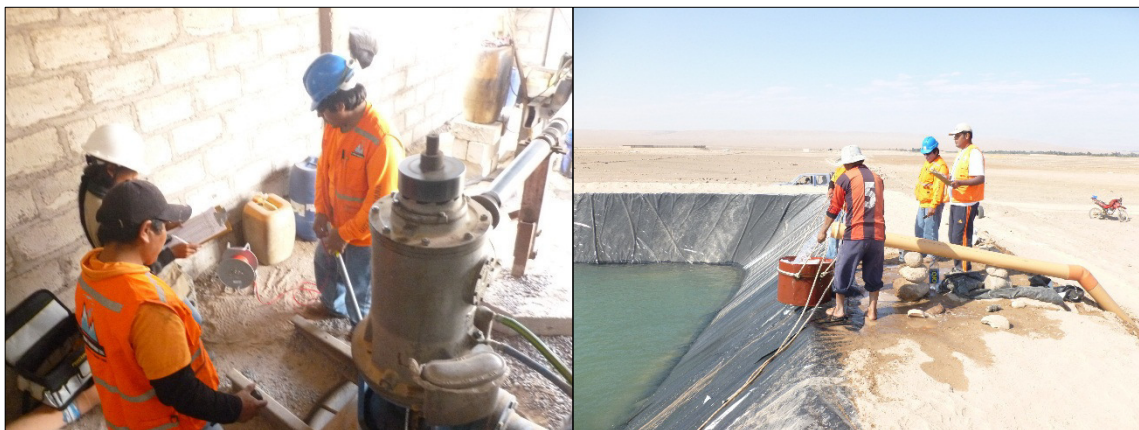
Foto 27 y 28: Medición de niveles de descenso en el pozo N°02 de la Asoc. Tierra Prometida (Coordenadas UTM WGS-84: 346102 Este y 7998203 Norte) y medición de caudales por el método volumétrico, mediante un cilindro calibrado y un cronómetro.
