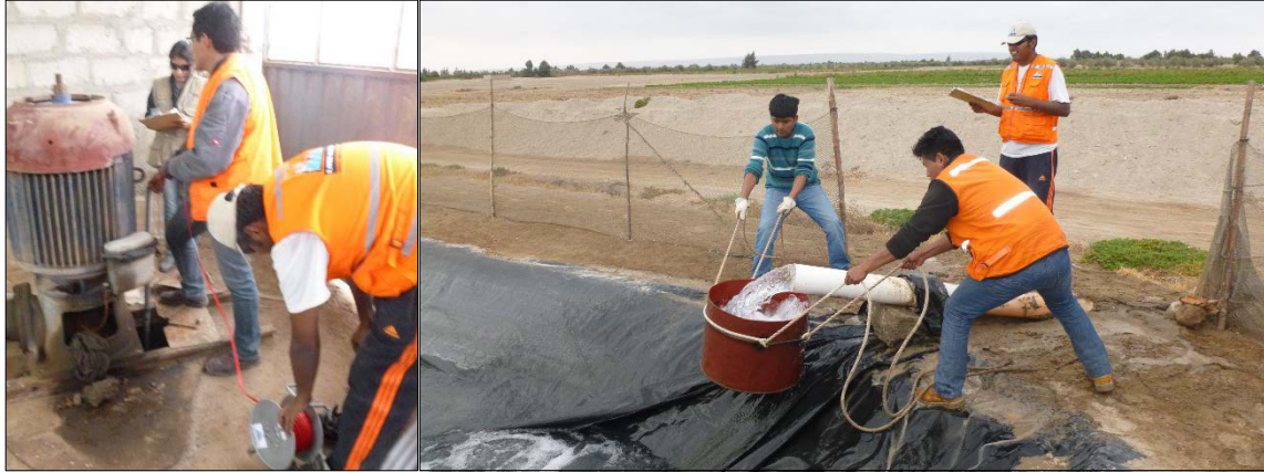
Foto 11 y 12: Medición de niveles de descenso en el pozo IRHS-307 (Coordenadas UTM WGS-84: 346258 Este y 7986754 Norte) y medición de caudales por el método volumétrico, mediante el uso de un cilindro calibrado y un cronómetro.
