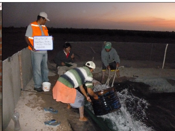
Foto 21 y 22: Medición de niveles de descenso en el pozo N°02 de la Asoc. Perú Posible (Coordenadas UTM WGS-84: 349275 Este y 7984546 Norte) y medición de caudales por el método volumétrico, mediante el uso de un cilindro calibrado y un cronómetro.
