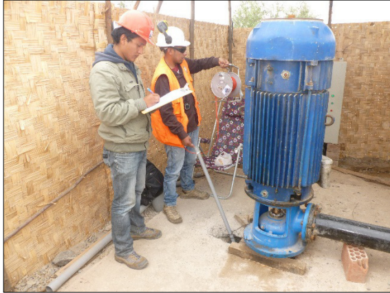
Foto 17 y 18: Medición de niveles de descenso en el pozo La Rosa de la Asoc. Flor de Primavera - Pachacutec (Coordenadas UTM WGS-84: 348775 Este y 7985869 Norte) y medición de caudales por el método volumétrico, mediante el uso de un cilindro calibrado y un cronómetro.
