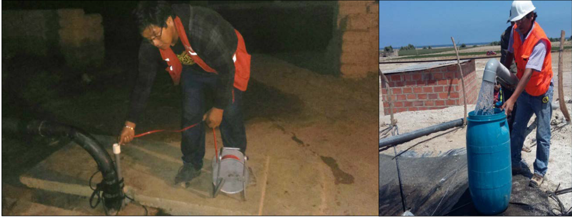
Foto 23 y 24: Medición de niveles de descenso en el pozo Nueva esperanza de la Asoc. Pueblo Libre (Coordenadas UTM WGS-84: 340800 Este y 7990408 Norte) y medición de caudales por el método volumétrico, mediante un cilindro calibrado y un cronómetro.
