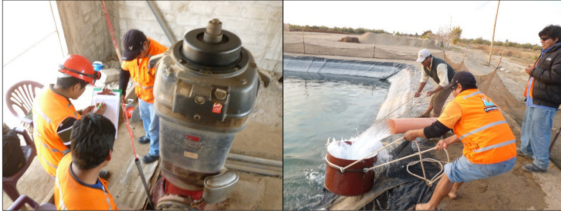
Foto 5 y 6: Medición de niveles de descenso en el pozo IRHS-157 (Coordenadas UTM WGS-84: 349767 Este y 7985380 Norte) y medición de caudales por el método volumétrico, mediante el uso de un cilindro calibrado y un cronómetro.
