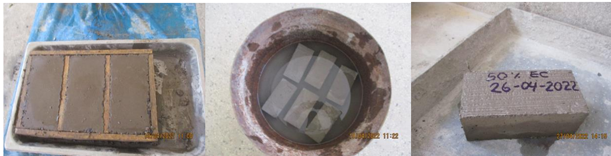
Diseño de mezcla, moldeado, vibrado y curado de adoquines de concreto con 50 % EFC
