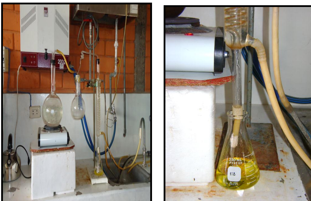
Figura 13. Equipo para el análisis de bases volátiles nitrogenada totales de jurel.
