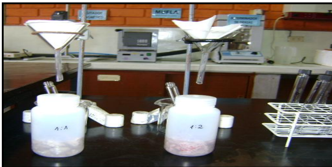
Figura 14. Filtración de las muestras de 1:1 y 2:1, para obtención de TMA.
