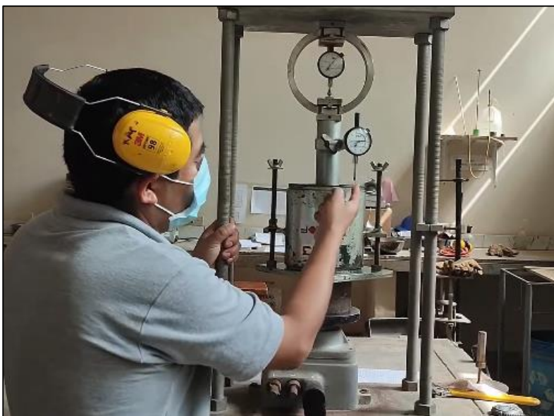
Figura 23: Lectura obtenida en la prensa CBR a 0.1" y 0.2"
