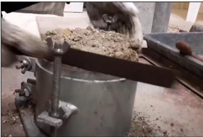
Figura 18: Enrasado del material en el molde
