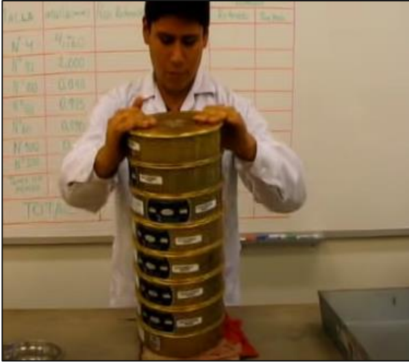
Figura 11: Tamizado del material
