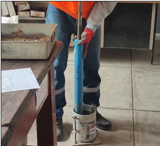
Figura 21: Aplicación del ensayo proctor modificado según ASTM D1883
