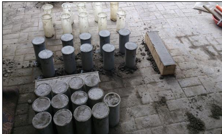
Imagen N°40: Mezclas de concreto para vigas y probetas
