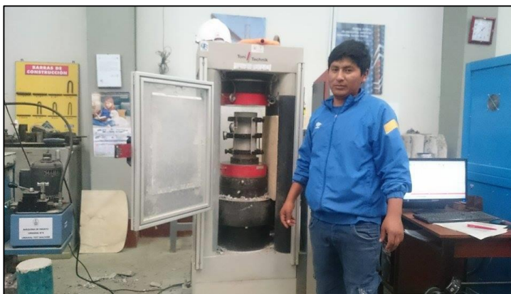
Imagen N°50: Radio de poisson del concreto
