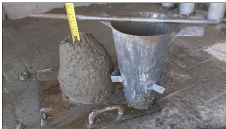
Imagen N°41: Asentamiento del concreto en estado fresco
