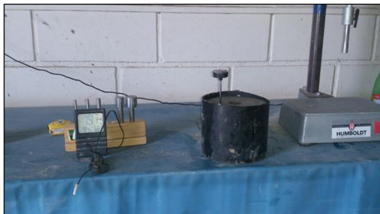
Imagen N°45: Tiempo de fraguado del concreto
