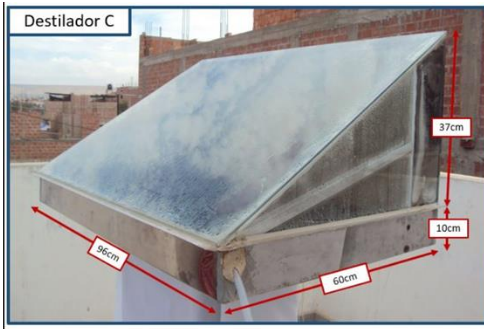
Figura 4. Destilador solar D3 tipo caja de una sola vertiente sin aislante térmico
