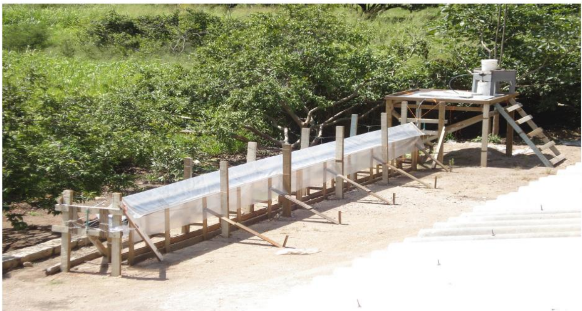
Figura 1. Equipo de destilación solar en la obtención de alcohol
