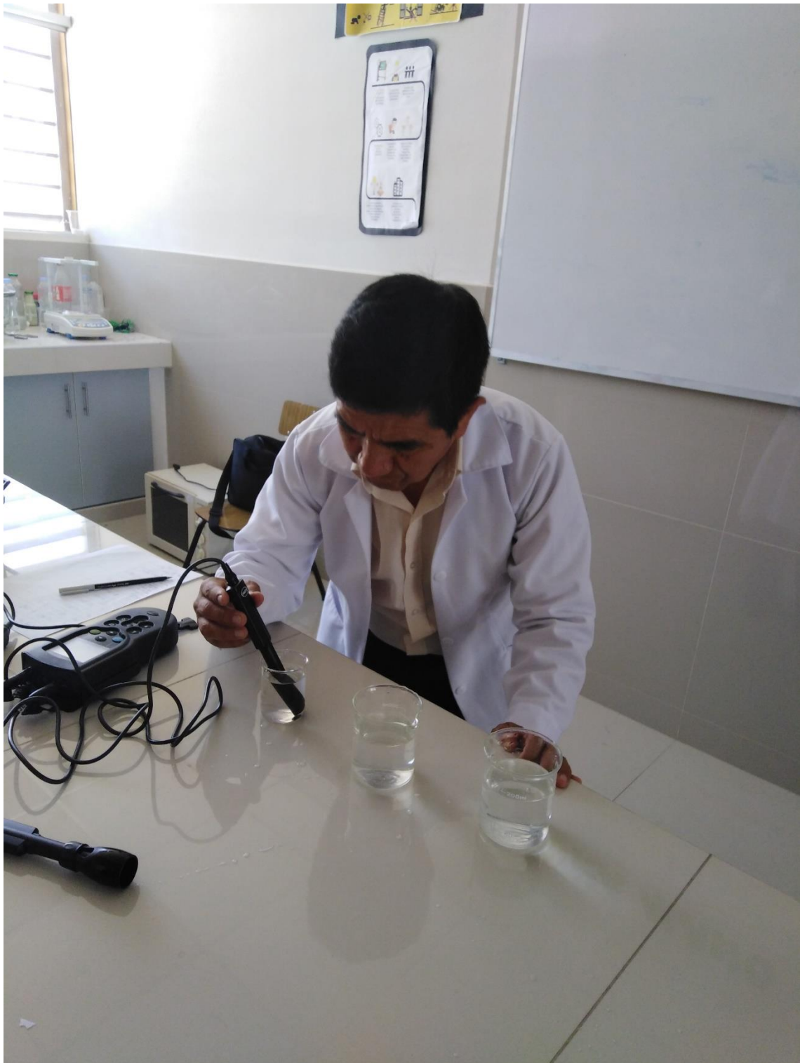
Figura 9. Determinación de pH y conductividad eléctrica de las muestras de agua destilada de mar con un multiparámetro.
