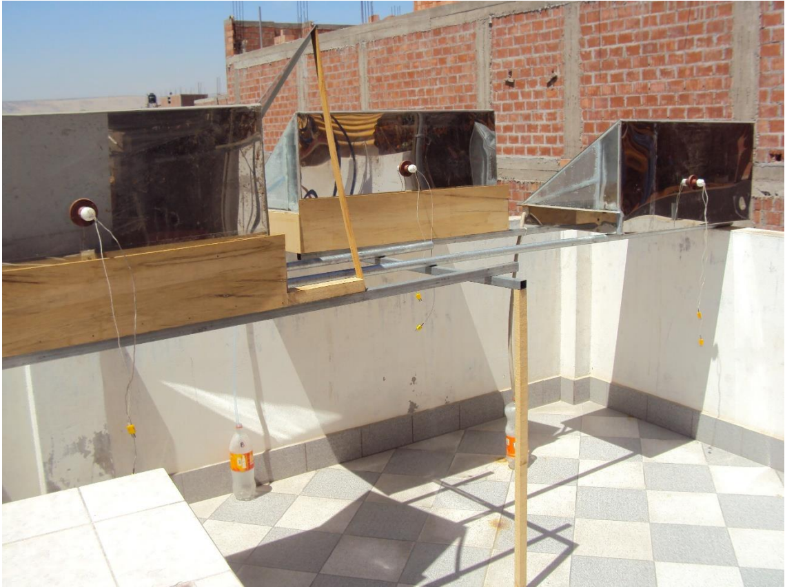
Figura 8. Tres destiladores solares de agua de mar.
