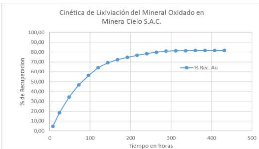
Figura 13. Cinética de lixiviación del mineral para malla 0,635 cm (¼") Fuente: Elaboración Propia (2017)
